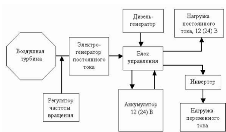
Рисунок 3.1. Загальна схема під'єднання вітроустановки
