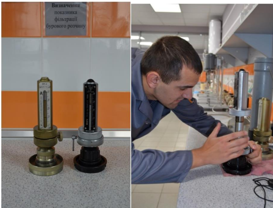
Рисунок 5.10 – Вимірювання показника фільтрації приладом ВМ-6
