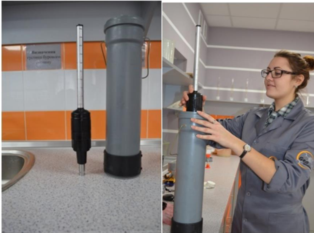
Рисунок 5.6 – Вимірювання густини промивальної рідини за допомогою ареометра АБР-1М
