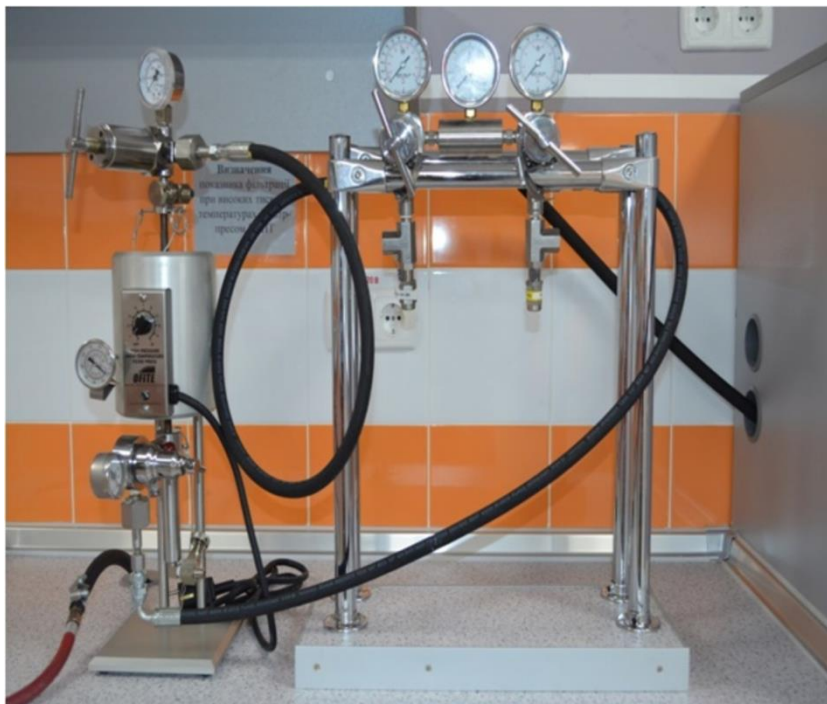
Рисунок 5.12 – Прилад фільтр-прес (НРНТ) за стандартом API 13B для визначення фільтрації за високого тиску та високої температури
