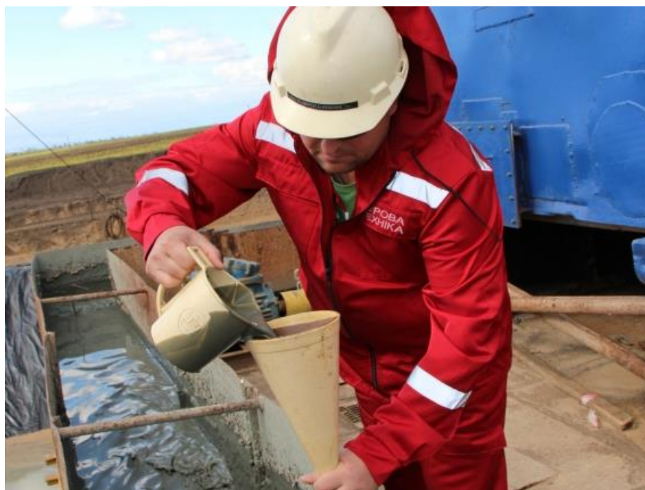
Рисунок 5.4 – Вимірювання умовної в'язкості промивальної рідини на буровій у польових умовах (НТП «Бурова техніка»)
