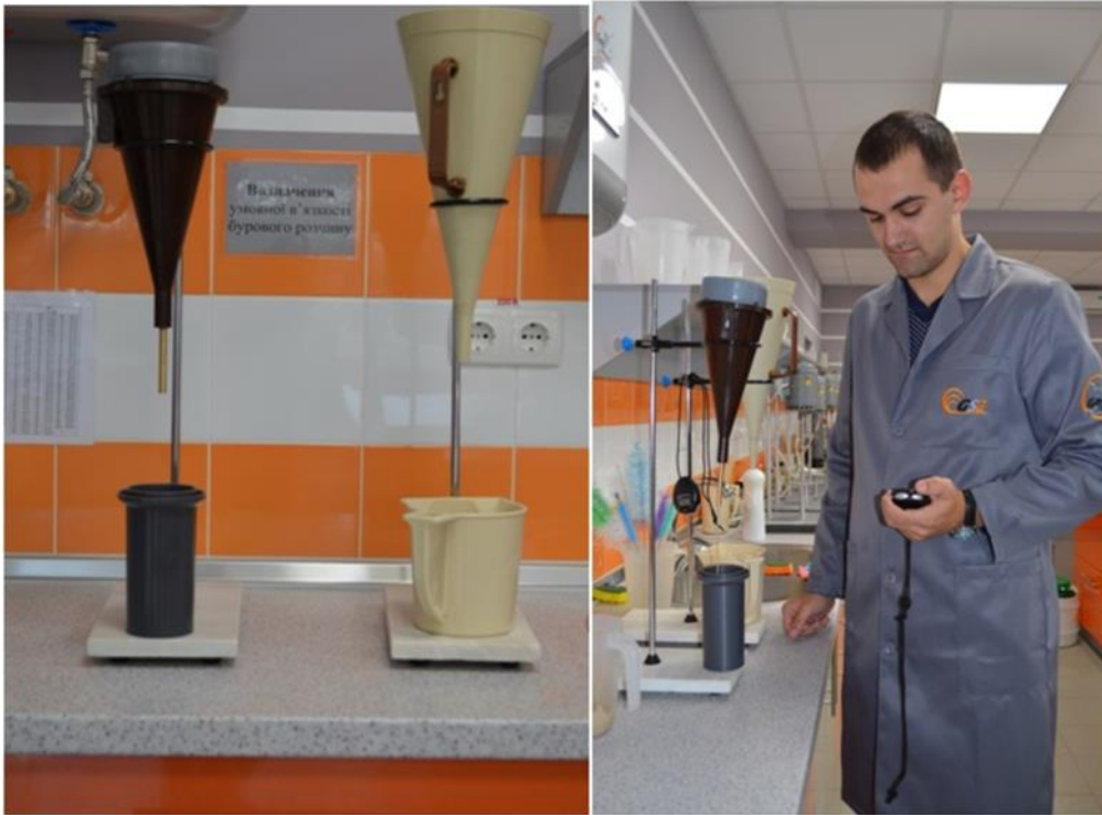
Рисунок 5.7 – Вимірювання умовної в'язкості віскозиметром ВП-5 (воронка Марша за API 13B)
