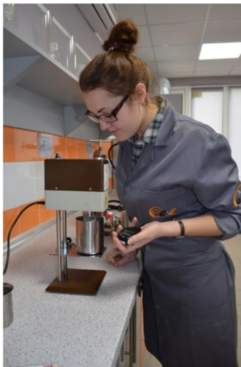
Рисунок 5.8 – Вимірювання реологічних властивостей 8-швидкісним віскозиметром OFITE 800
