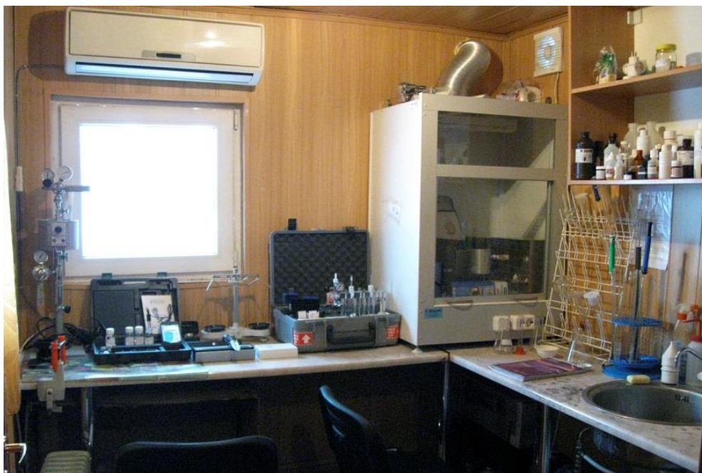
Рисунок 5.2 – Польовий вагон-лабораторія промивальних рідин (НТП «Бурова техніка»)
