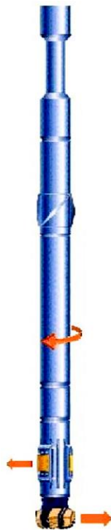
Рисунок 2.3 – Загальний вигляд компоновки бурового інструмента з гвинтовим вибійним двигуном
