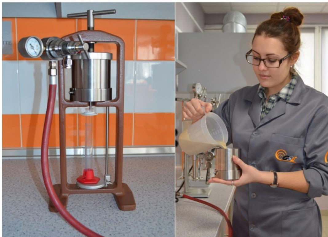
Рисунок 5.11 – Вимірювання статичної фільтрації фільтр-пресом настільним за стандартом API 13B
