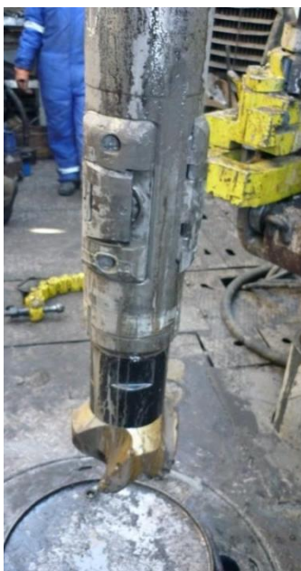
Рисунок 3.5 – Роторна керована система перед спуском у свердловину
