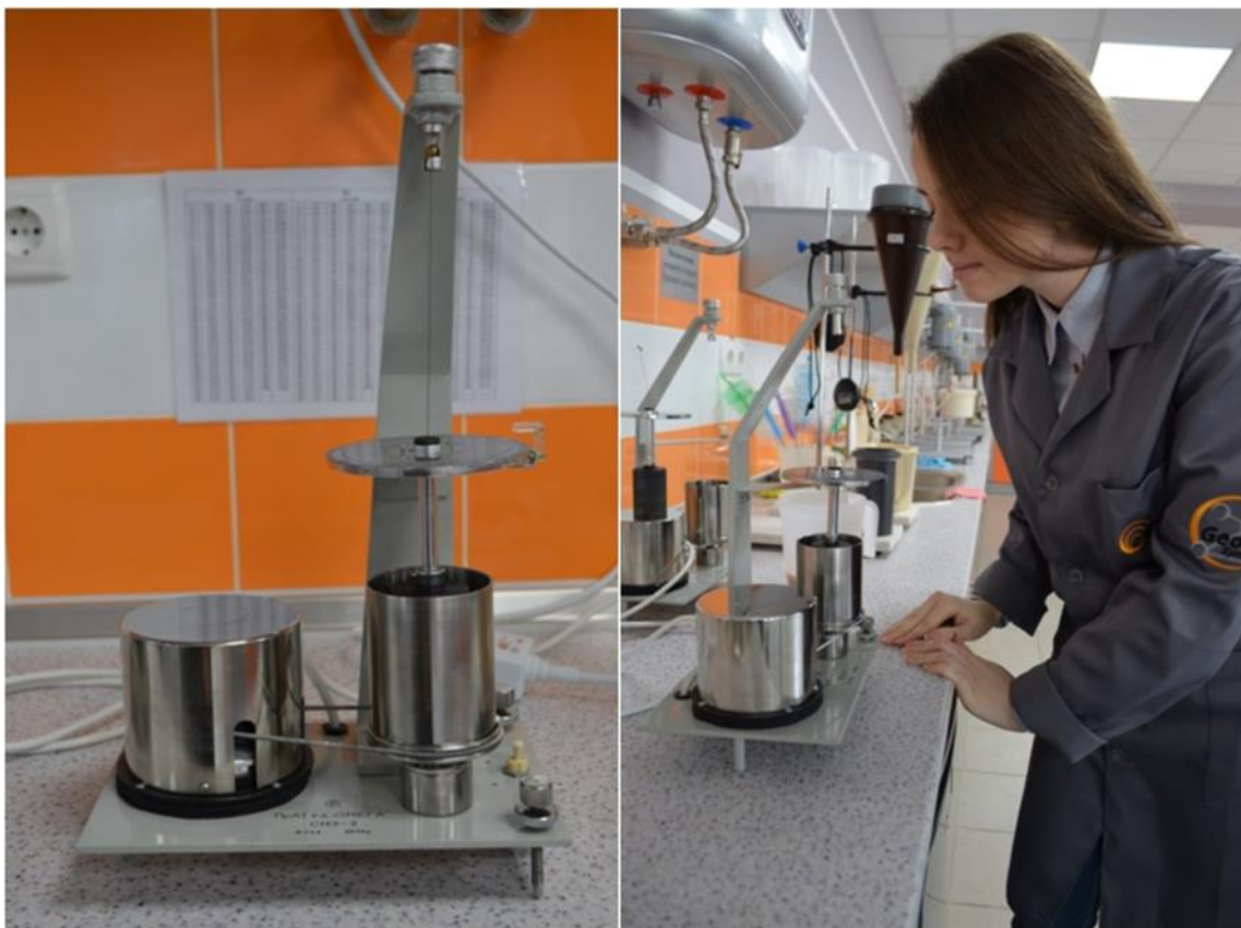
Рисунок 5.9 – Вимірювання статичного напруження зсуву (CH3) на приладі СНС-2
