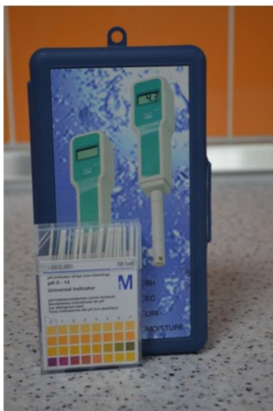
Рисунок 5.15 – Прилад pH -метр для визначення водневого показника pH , який характеризує концентрацію іонів водню у промивальній рідині
