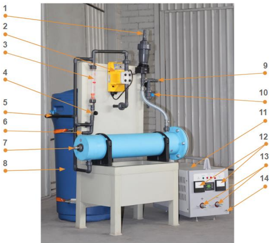
Рисунок 12.1 – Установка приготування розчину гіпохлориту натрію:
