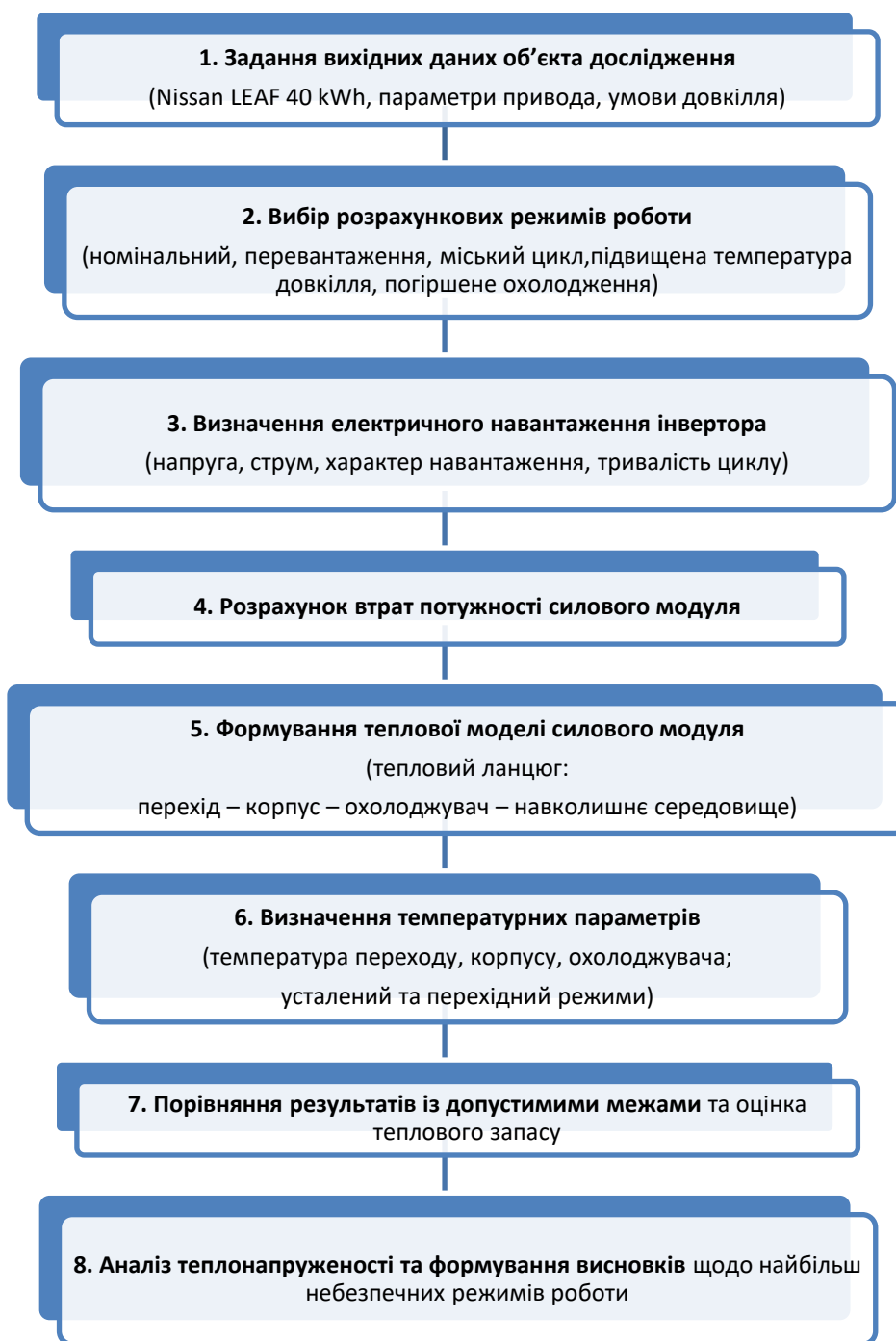
Рисунок 2.1 – Блок-схема методики розрахунку температурних режимів силового модуля тягового інвертора
