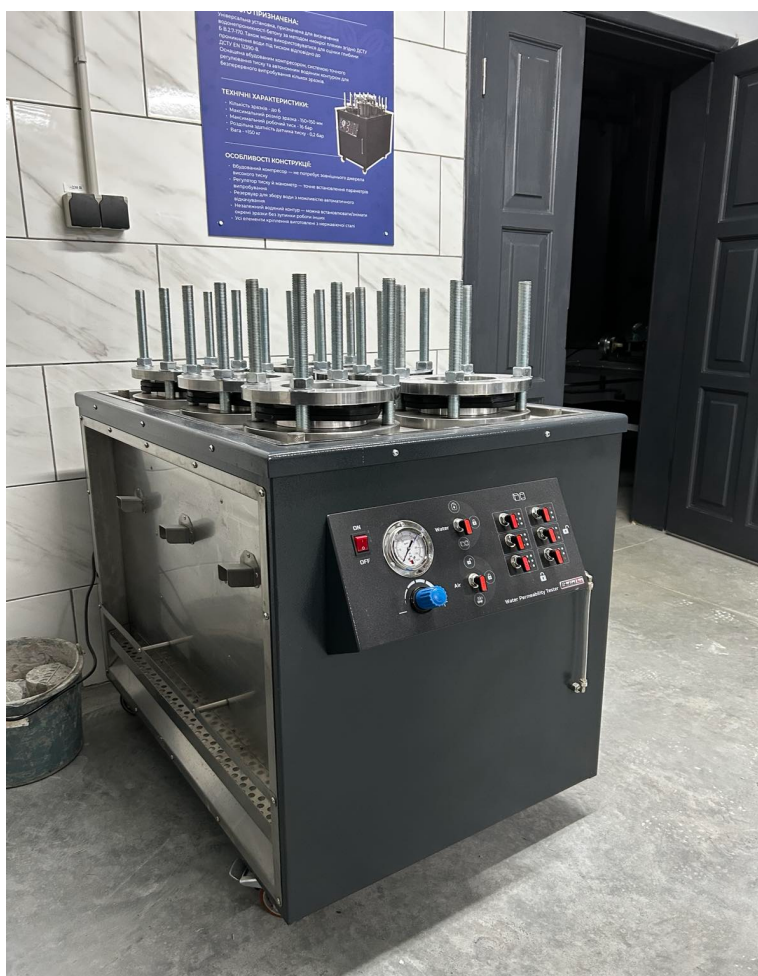
Рисунок 1.4 – Установка для випробування бетону на водонепроникність
