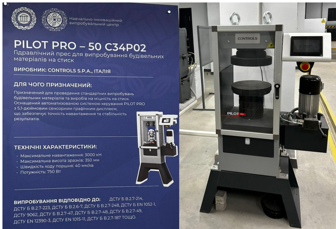
Рисунок 1.2 – Гідравлічний прес для випробування будівельних матеріалів на тиск
