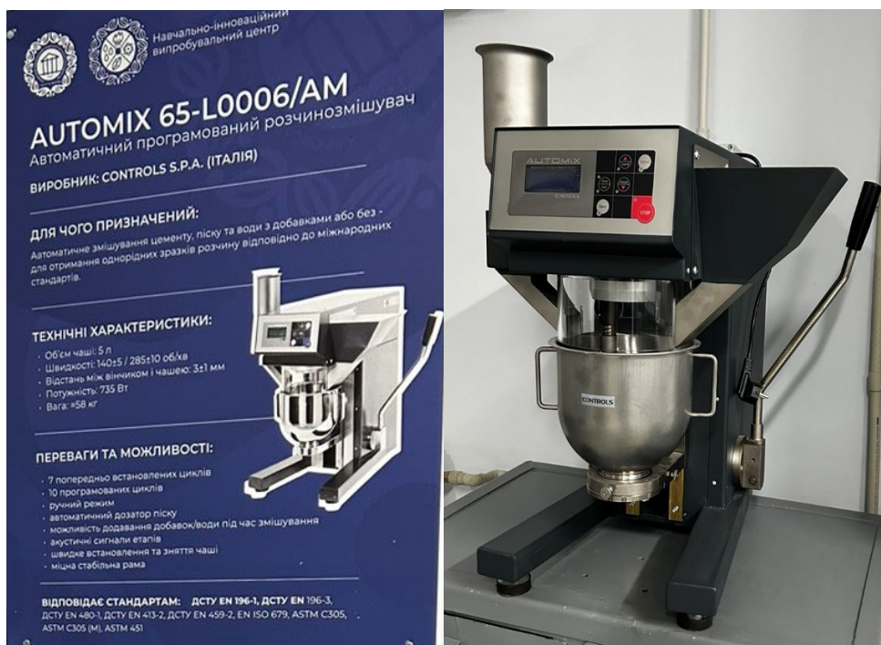
Рисунок 1.5 – Автоматичний програмований розчинозмішувач
