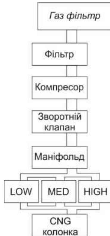
Рисунок 2.3 – Схема каскадної системи накопичення та подачі природного газу
