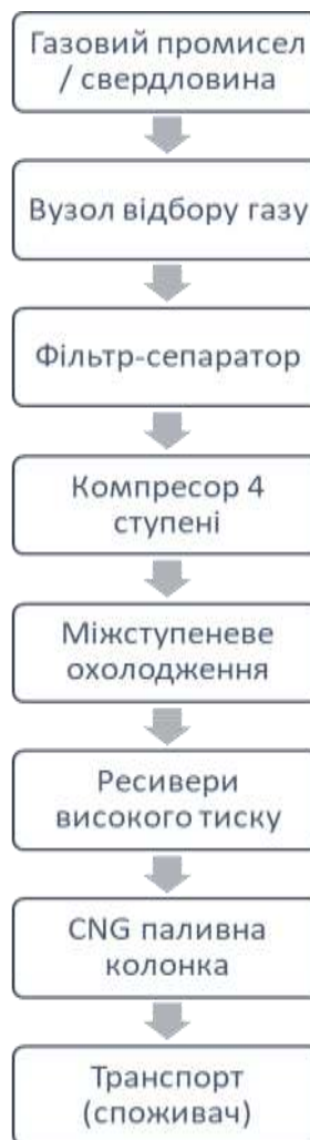
Рисунок 1.1 – Структура роботи мобільної АГНКС на промислі
