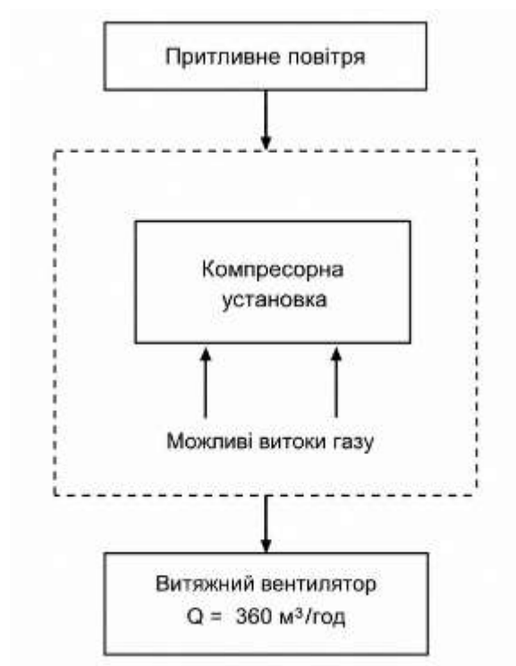
Рисунок 4.1 – Схема вентиляції компресорного відсіку мобільної АГНКС
