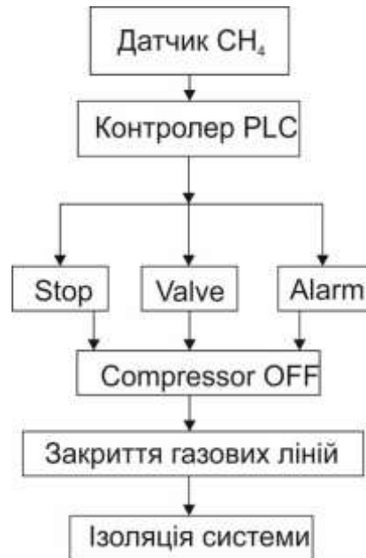
Рисунок 2.6 – Алгоритм аварійного відключення мобільної АГНКС при спрацюванні газоаналізатора
