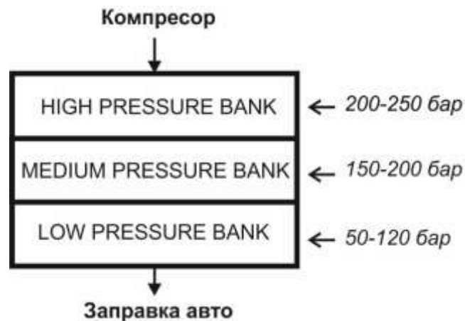
Рисунок 2.2 – Схема каскадного накопичення газу
