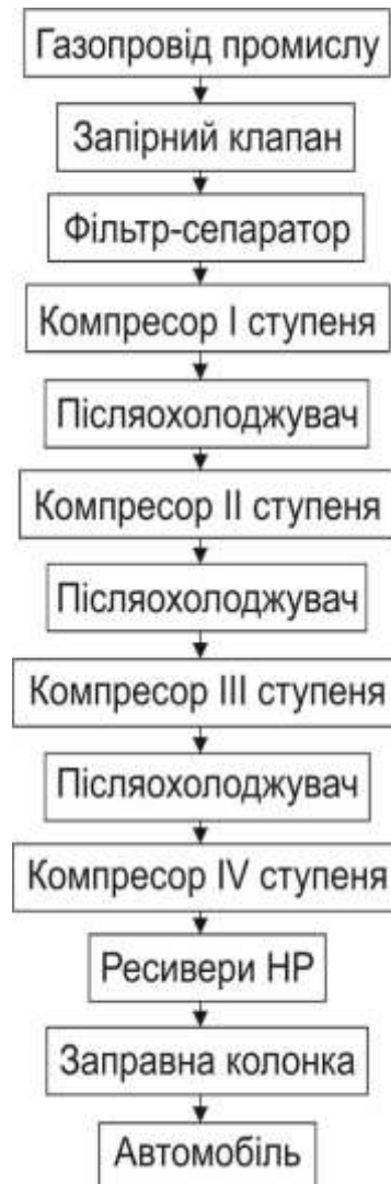
Рисунок 2.1 – Принципова технологічна схема мобільної АГНКС
