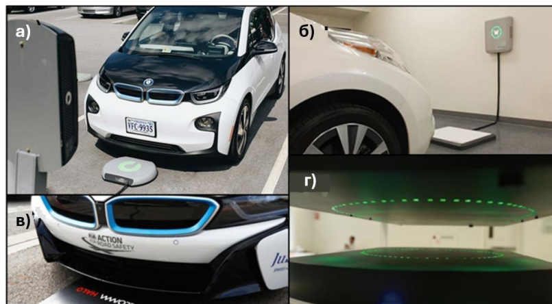
Рисунок 1.4 – Сучасні технології бездротового заряджання електромобілів:
