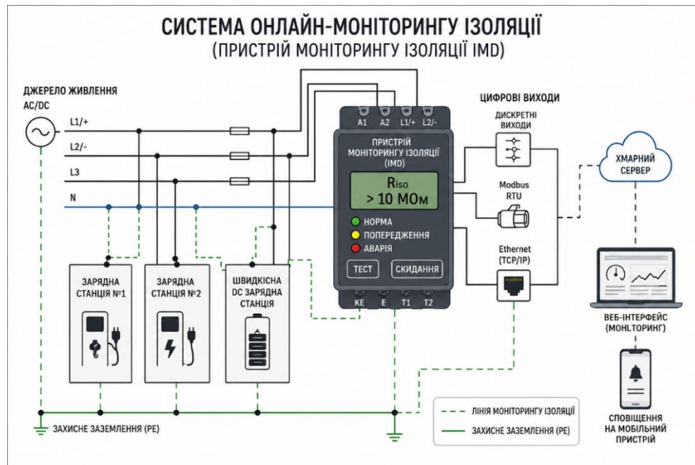
Рисунок 4.1 – Схема підключення систем моніторингу ізоляції у системі зарядної станції
