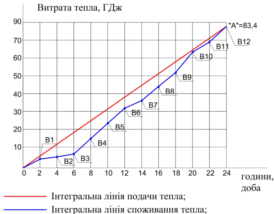
Рисунок 2.1 – Інтегральний графік системи гарячого водопостачання
