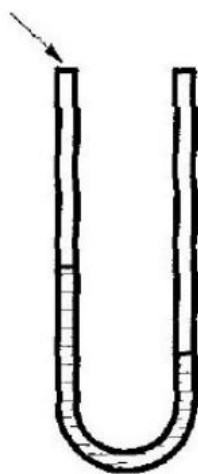
Рисунок 2.8.2 – Експрес метод оцінки в'язкопластичних властивостей нафти
