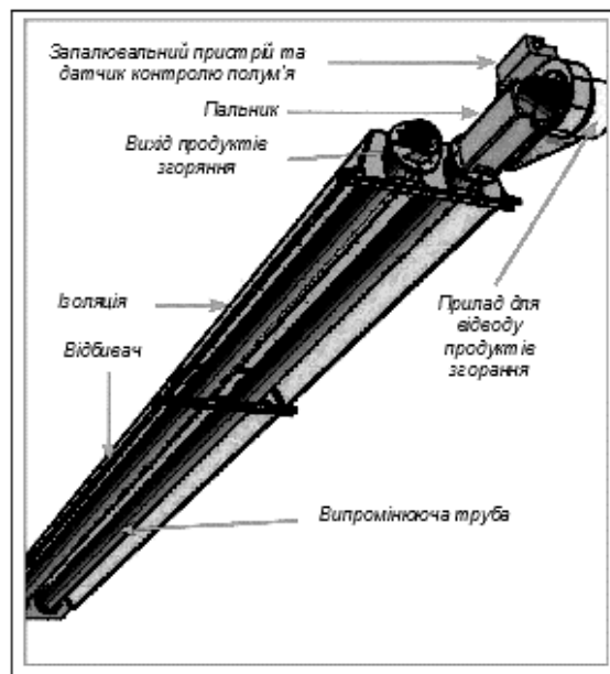
Рисунок 17.1 – Схема інфрачервоного газового випромінювача
