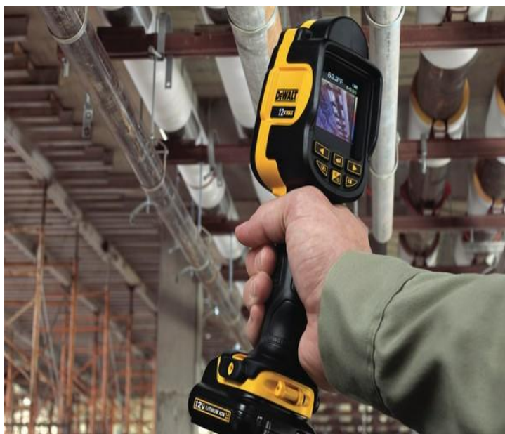
Рисунок 3.1 – Вимірювання температури поверхні трубопроводів за допомогою тепловізора
