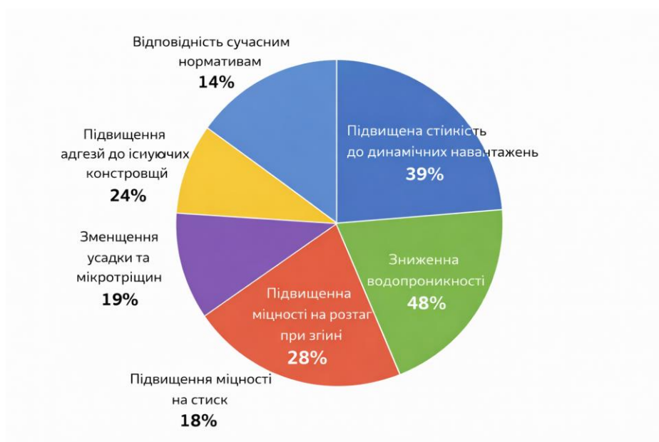
Рисунок 2.3 – Переваги методу посилення ґрунтів основ мікропаллями
