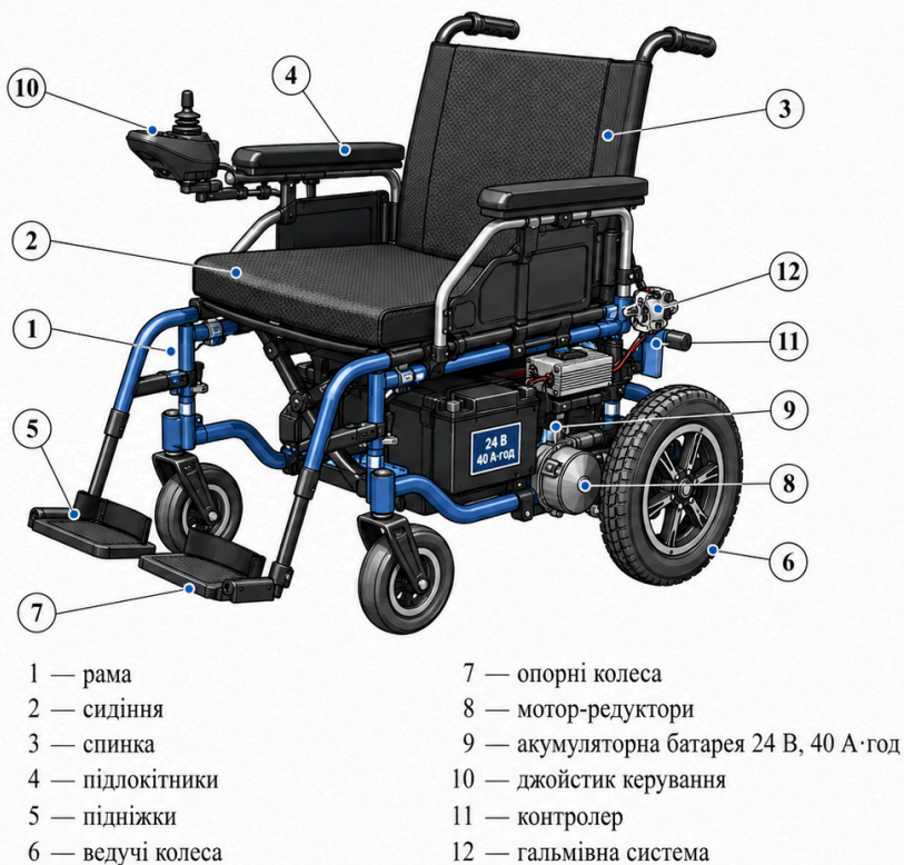
Рисунок 2.1 – Загальний вигляд та основні вузли електричної інвалідної коляски
