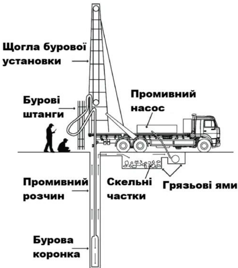
Рисунок 1.1 – Схема буріння свердловини комбінованим роторно-пневматичним способом
