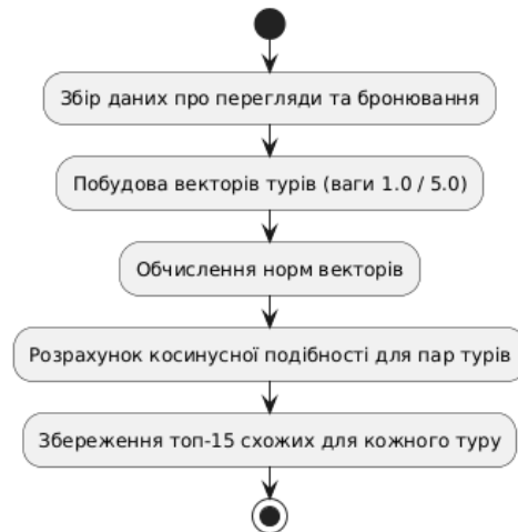
Рисунок 2.4 – Схема алгоритму побудови матриці подібності турів у системі «VipVoyage»
