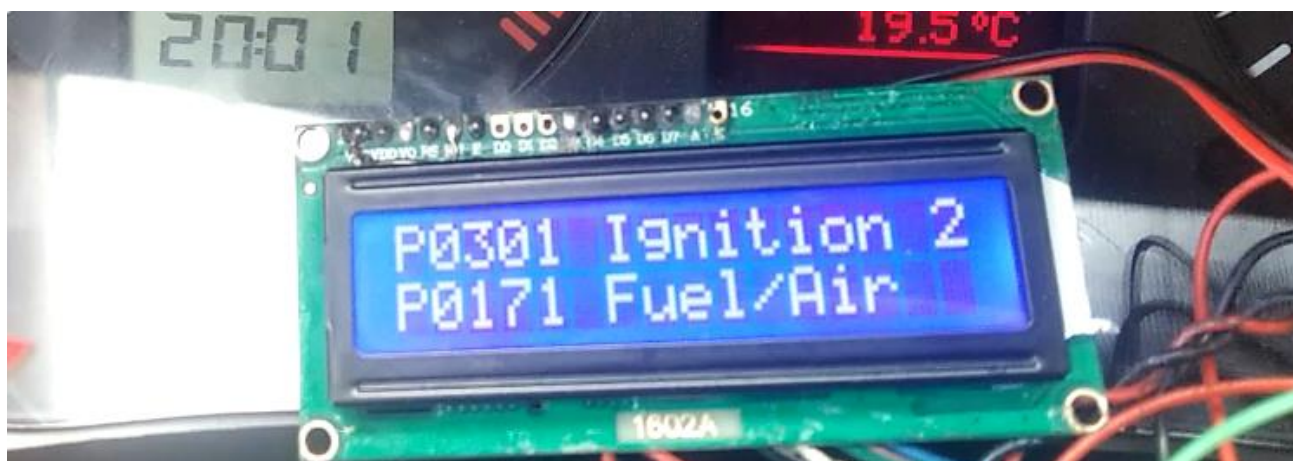
Рисунок 3.27 — Зчитування сервісних кодів помилок з пам'яті ЕБК.
