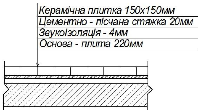
Рисунок 3.1 – Склад перекриття будівлі
