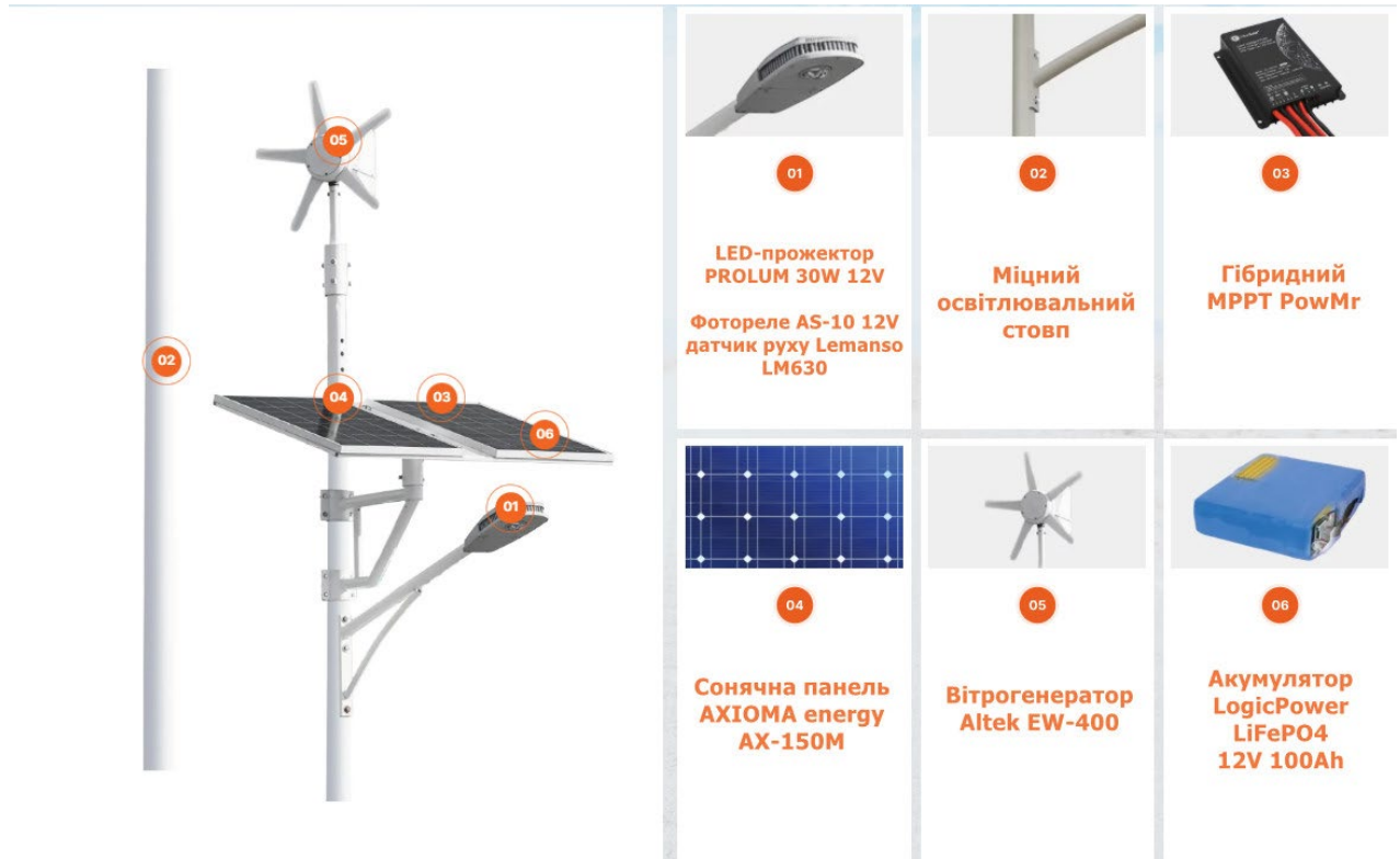
Рисунок 3.6 – Просторове компонування та структура елементів гібридного вуличного ліхтаря
