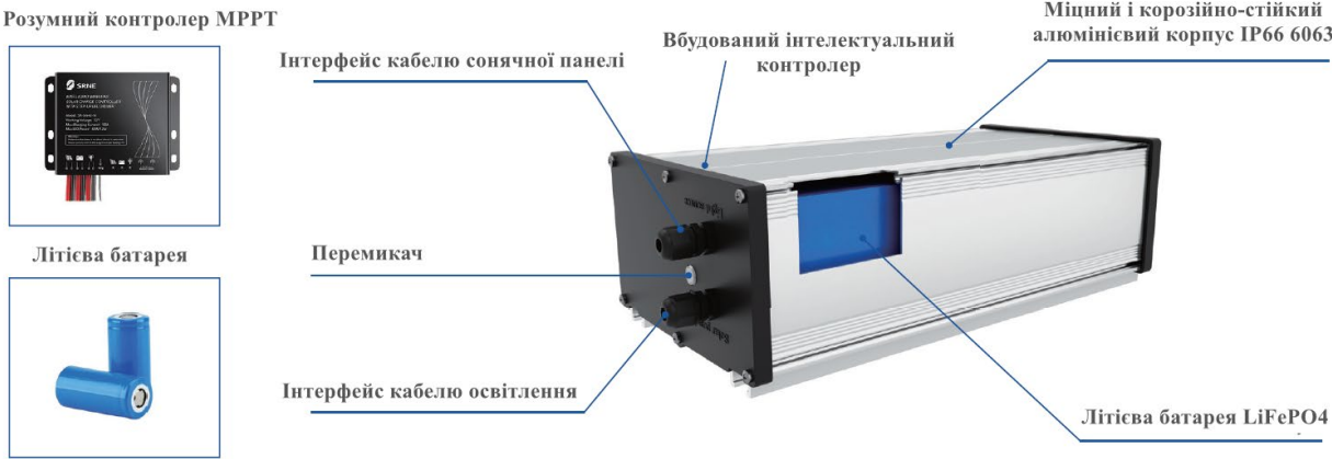
Рисунок 3.2 – Конструктивне розміщення буферної літій-залізо-фосфатної батареї та мікропроцесорного контролера керування в герметичному антивандальному боксі
