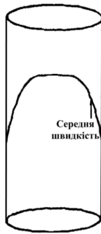
Рисунок 6.7 – Профіль швидкості руху неньютонівських рідин (ламінарний режим)
