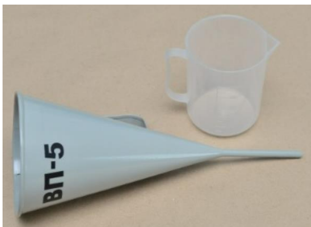
Рисунок 7.2 – Прилад ВП-5 для вимірювання умовної в'язкості
