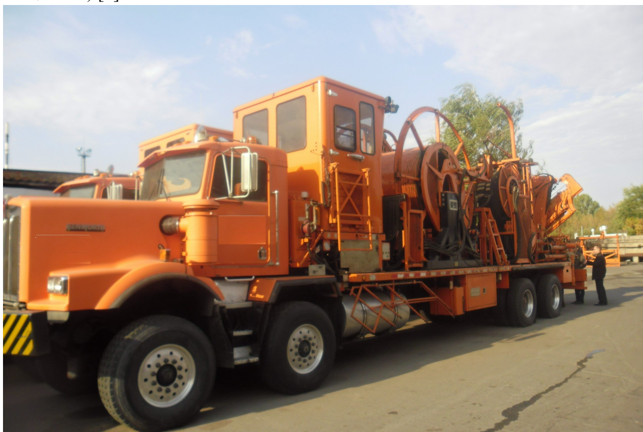
Рисунок 1.6 – Канадська колтбінгова установка на базі повнопривідного важкого шасі Kenworth [7]
