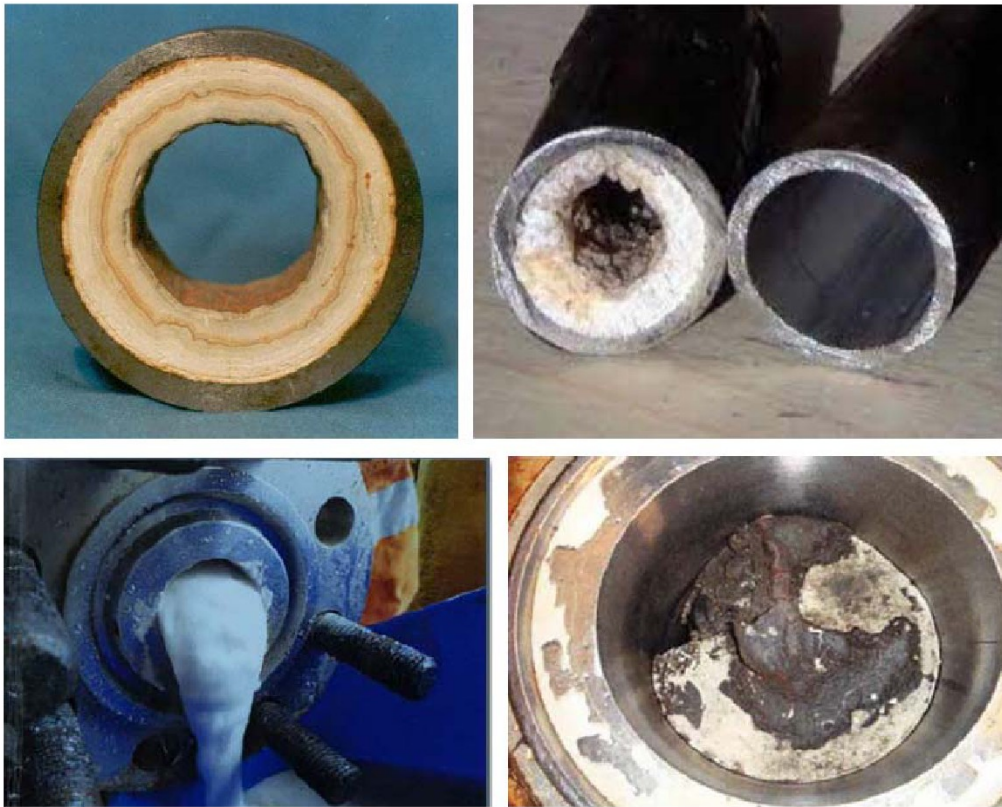
Рисунок 2.1 – Відклади солей в НКТ і на обладнанні свердловин [18]
