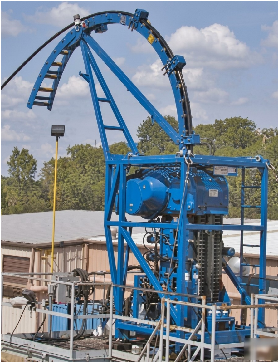
Рисунок 1.5 – Інжектор для спуску і підйому ГТ з інструментом у свердловину
