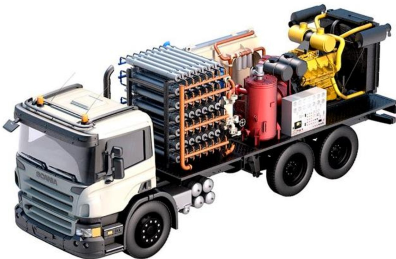
Рисунок 2.13 – Азотна компресорна станція ТГА
