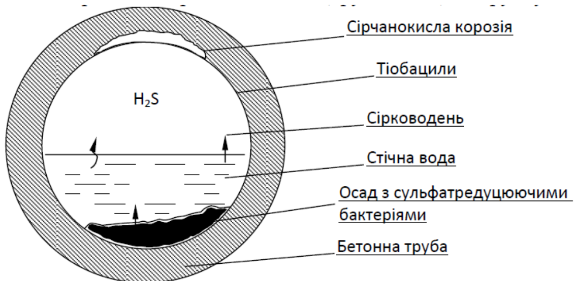
Рисунок 3.2 – Схема корозії бетонних труб
