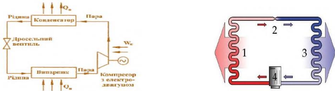
Рисунок 5.9 – Схема парокомпресійного теплового насоса: 1 – конденсатор; 2 – дросель; 3 – випарювач; 4 – компресор
