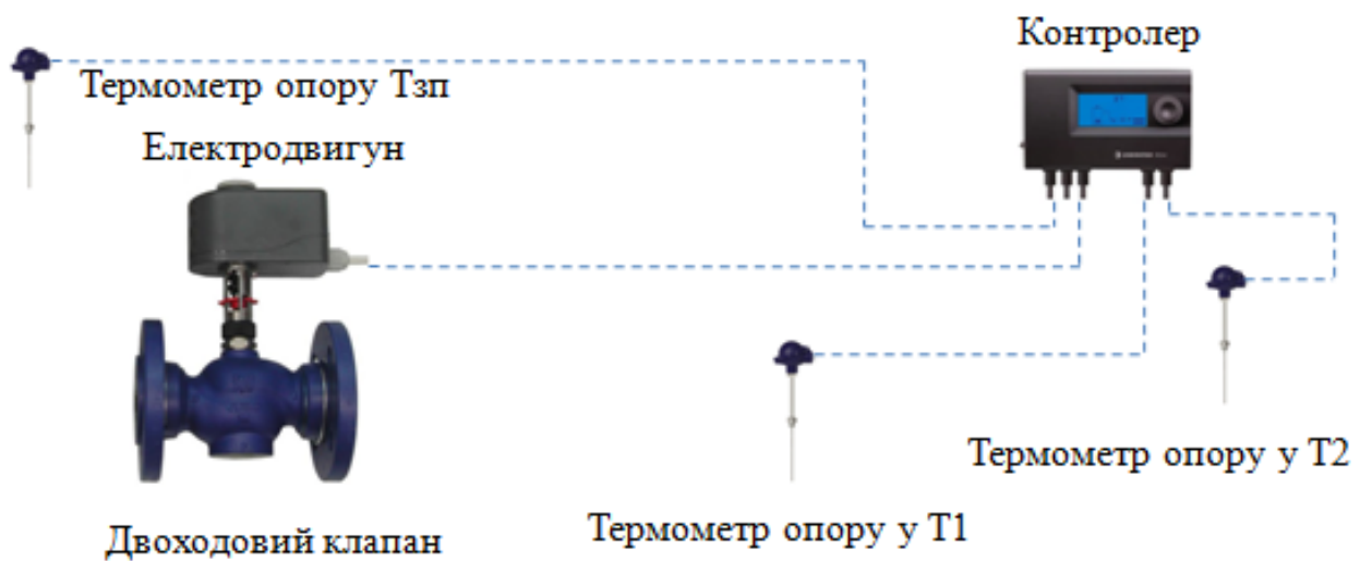
Рисунок 12.15 – Склад регулятора температури системи гарячого водопостачання
