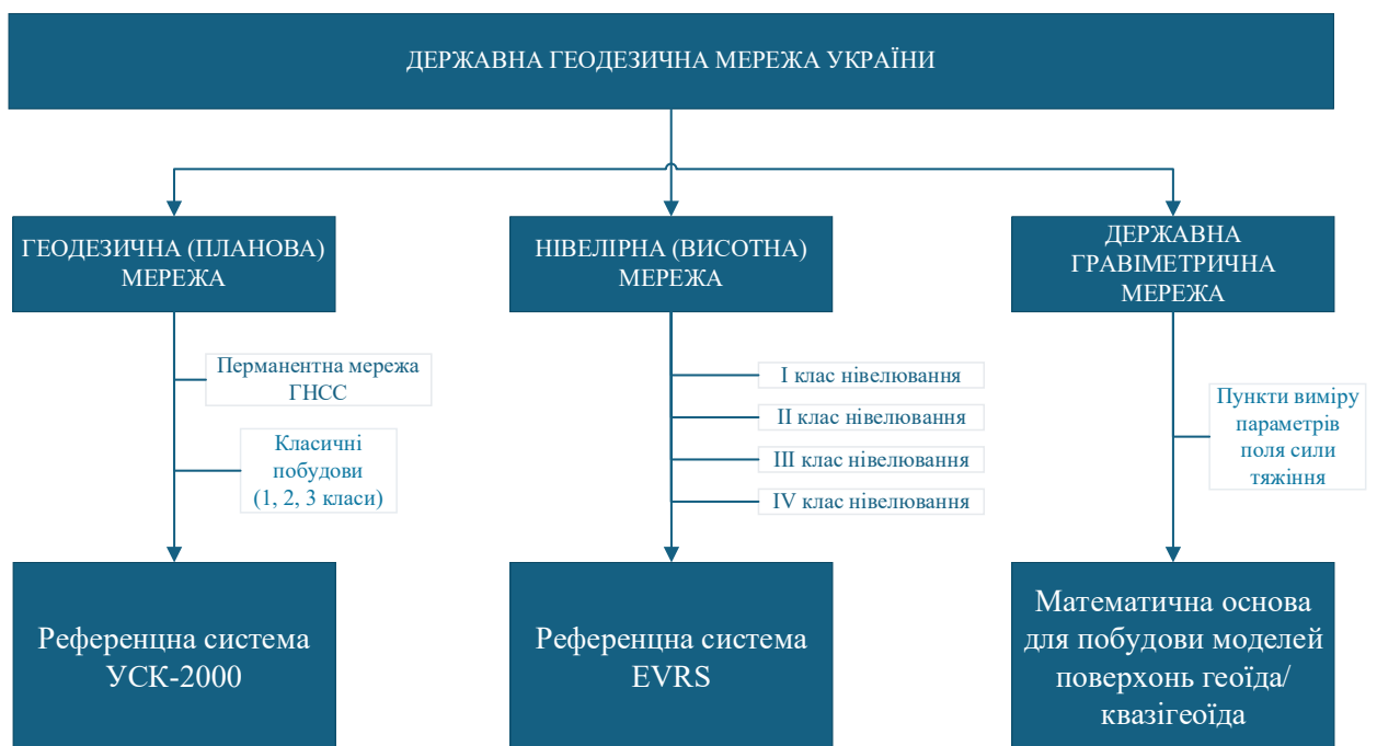
Рисунок 1.1 – Схема структури Державної геодезичної мережі
