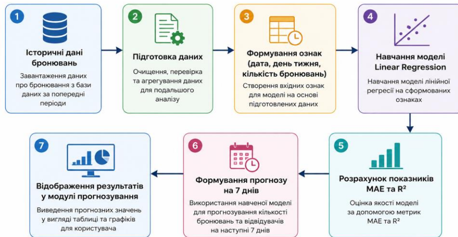
Рисунок 2.8 – Схема роботи модуля прогнозування відвідуваності
