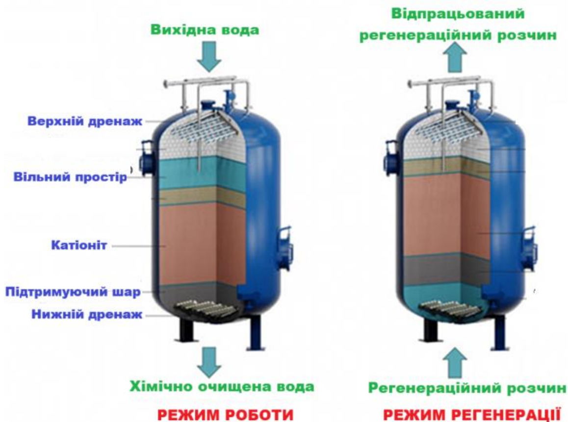
Рисунок 1.4 – Схема роботи катіонітового фільтра
