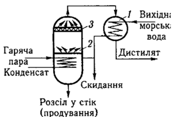
Рисунок 2.3 – Принципова схема однокорпусного випарника
