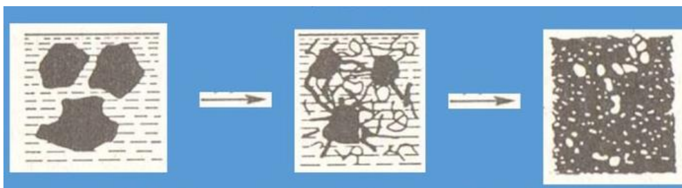
Рисунок 4.2 – Схема формування структури цементного каменю
