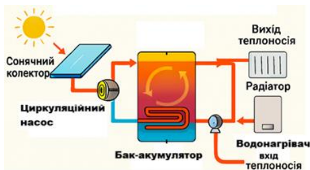
Рисунок 5.2 – Принципова схема комбінованої водяної системи сонячного теплопостачання
