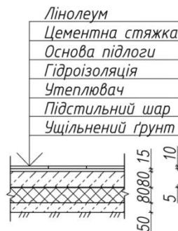
Рисунок 1.6 – Конструкція підлоги вкрито лінолеумом
