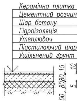
Рисунок 1.5 – Конструкція підлоги з керамічної плитки
