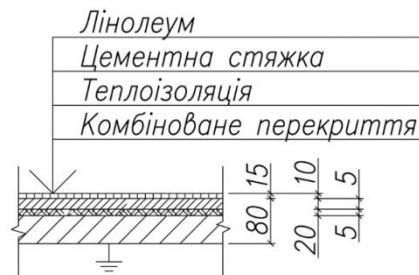
Рисунок 1.9 – Конструктивна схема вузла покриття підлоги з лінолеуму.
