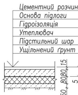
Рисунок 1.7 – Конструкція підлоги вкрито лінолеумом
