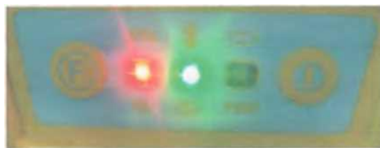
Рисунок 15.4 – Індикація режиму ровера з увімкненим GPRS-каналом
