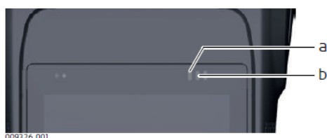
Рисунок 14.6 – Світлодіодні індикатори: а – індикатор акумулятора; b – індикатор GPS
