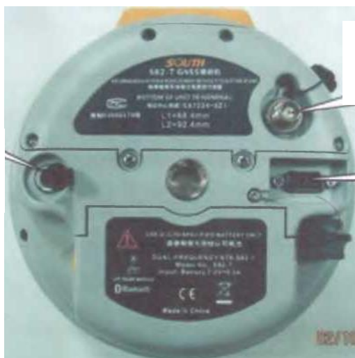
Рисунок 15.3 – Порти зв'язку основного блока S82T
