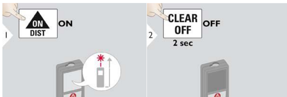
Рисунок 1.3 – Вмикання / вимикання приладу:
