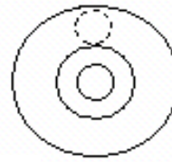
Рисунок 8.2 – Нуль-пункт круглого рівня
