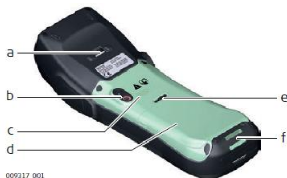
Рисунок 14.3 – Задня панель приладу Zeno 20: а – утримувач для ремня; b – камера із спалахом; c – динамік; d – відсік із слотами акумулятора, SIM-карти та SD-карти; e – важіль для відкриття акумуляторного відсіку; f – фіксатор ремня
