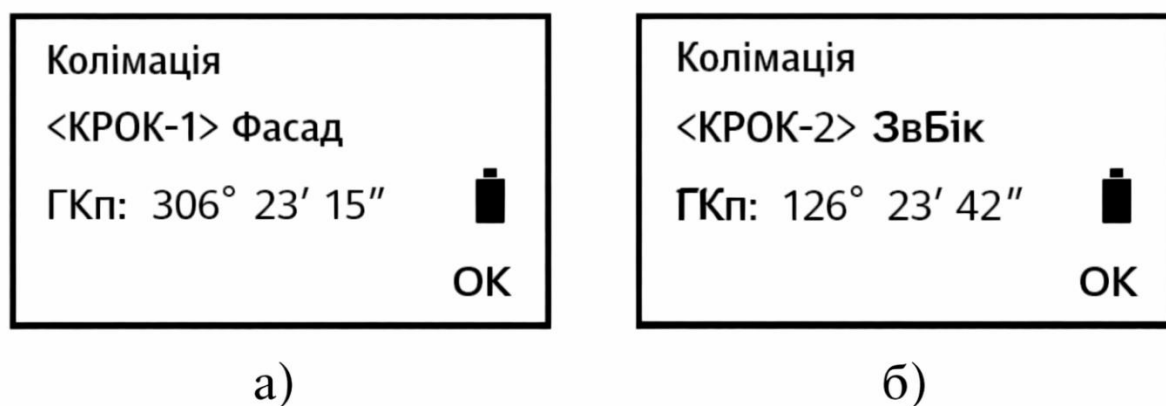
Рисунок 8.6 – Наведення на ціль А для електронного налаштування приладу
