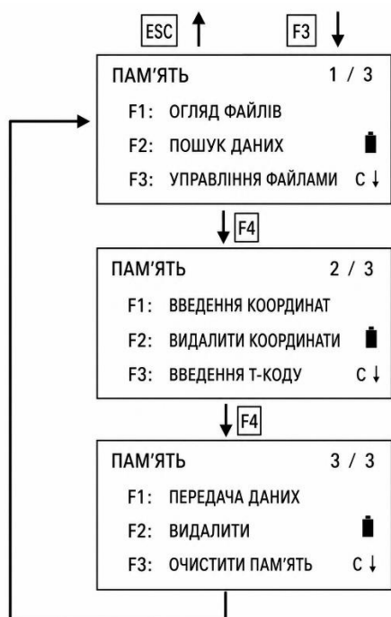
Рисунок 13.2 – Можливі дії із файлами тахеометра
