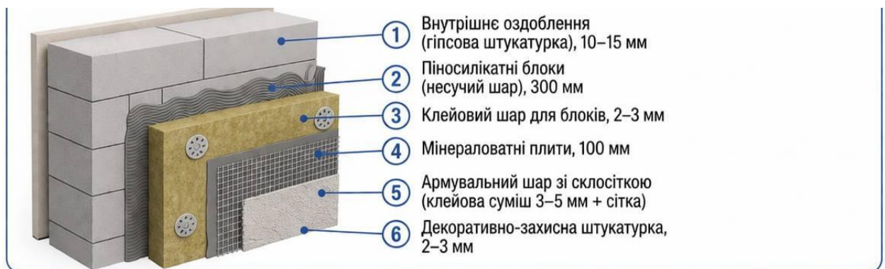
Рисунок 2.2.1 – Схема багатошарової стіни з піносілікатних блоків з мінераловатною теплоізоляцією
