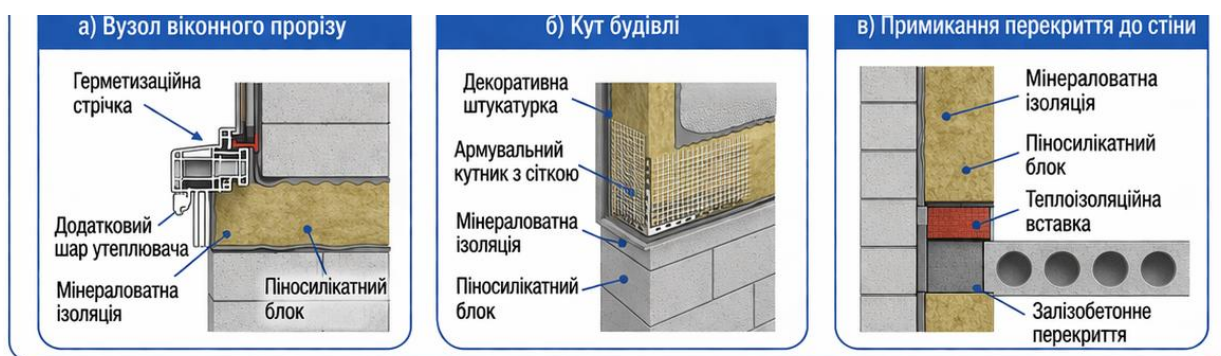
Рисунок 2.2.4 - Типові вузли примикання та заходи з енергоефективності
