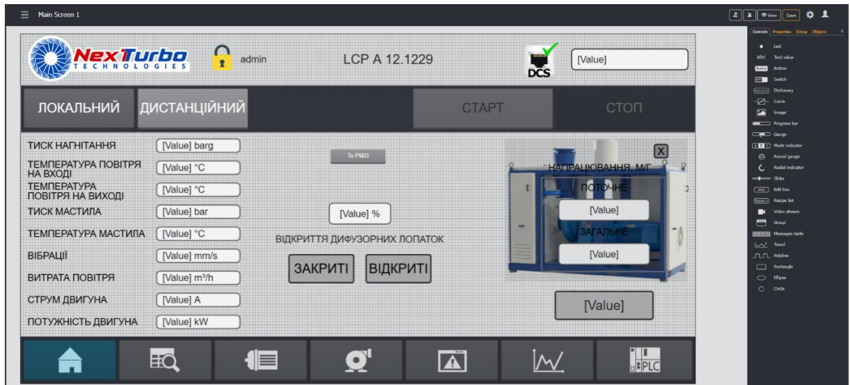
Рисунок 4.13 – Середовище розробки мнемосхем WebHMI PRO (режим редагування): головний екран Main Screen 1 у процесі проєктування з переліком доступних елементів на бічній панелі
