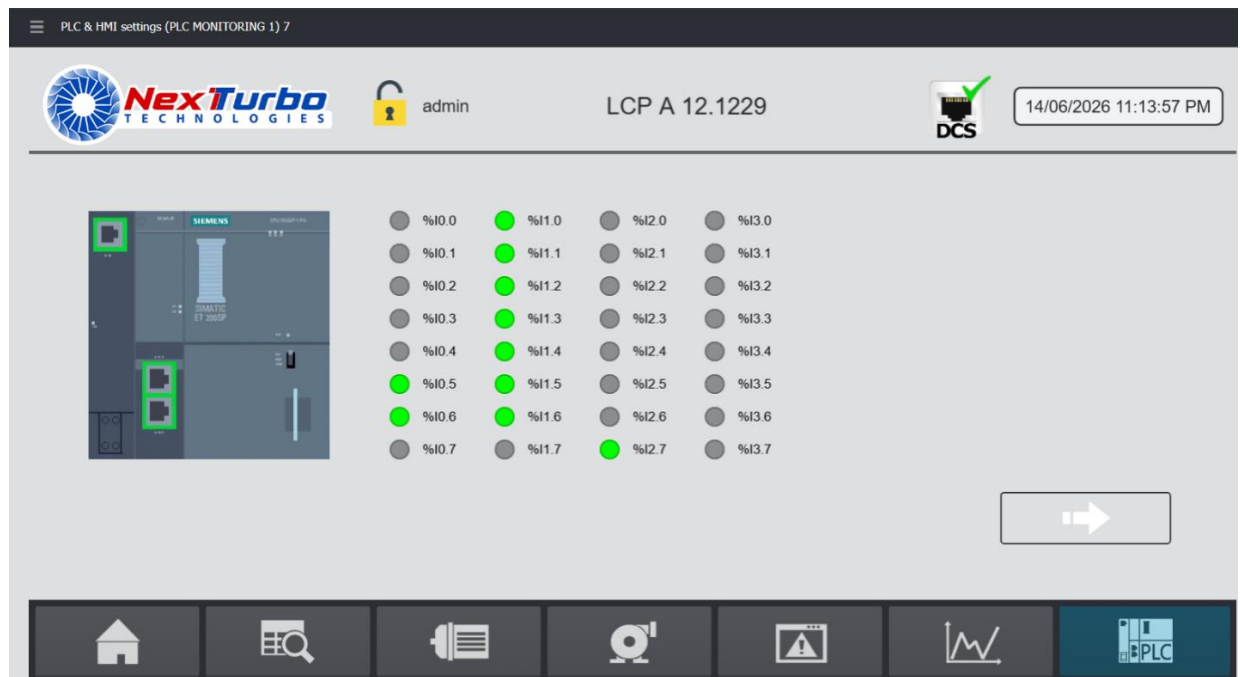
Рисунок 4.20 – Службовий екран PLC & HMI settings: стан дискретних входів ПЛК LCP у реальному часі через браузер для дистанційної діагностики без TIA Portal
