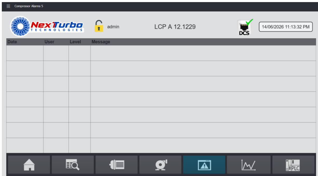
Рисунок 4.17 – Екран Compressor Alarms 5: таблиця журналу подій з датою, рівнем і текстом повідомлень, що автоматично формуються системою подій WebHMI
