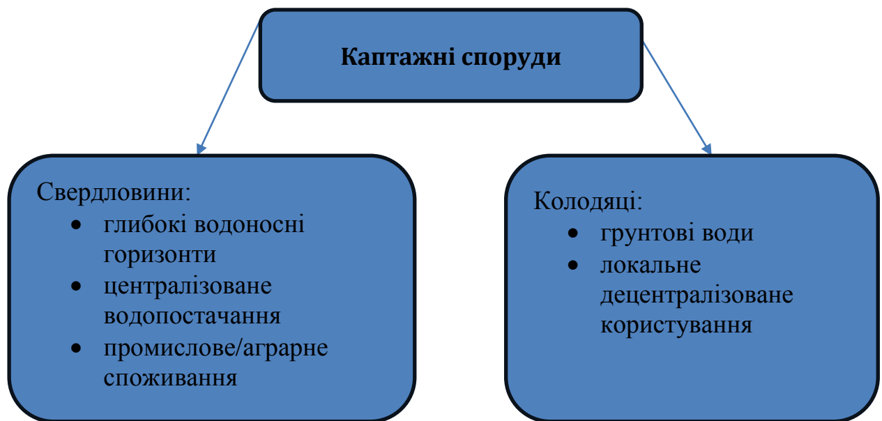
Рисунок 2.4 – Споруди вертикального водозабору
