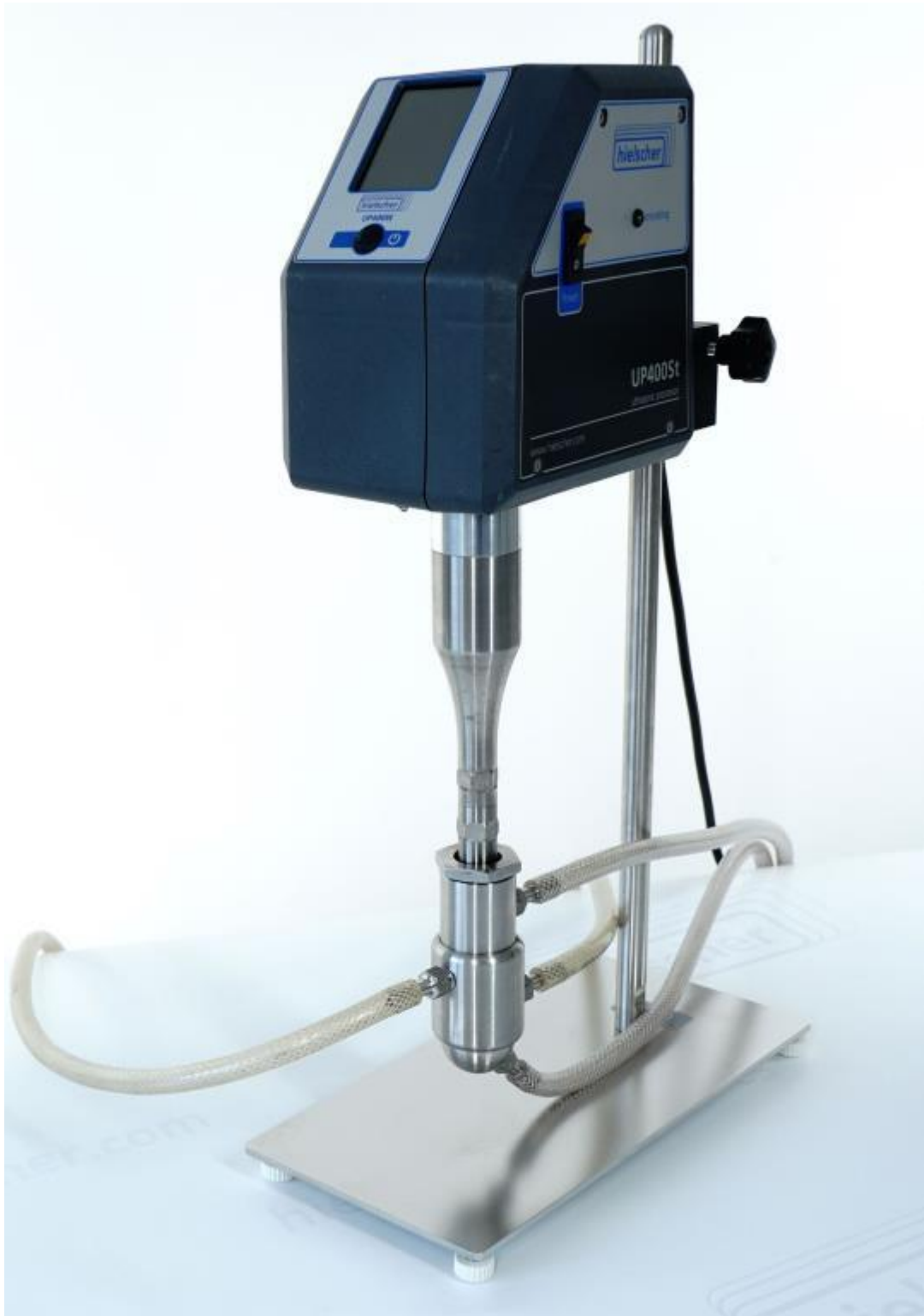
Рис. 5 Процесор UP400S в неперервному процесі з термостатованою проточною коміркою
