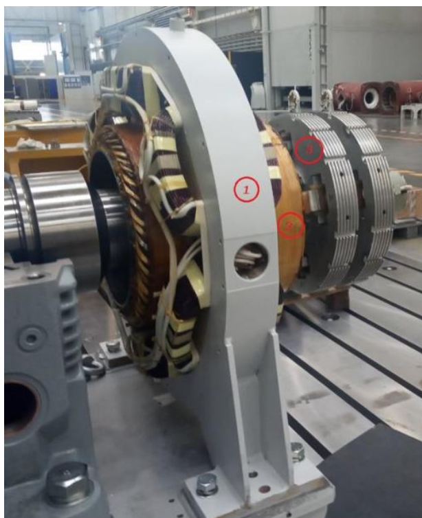
Рис. 1.8. Конструкція БВУ: 1 - статор, 2 - ротор, 3 - випрямляч, що обертається.
