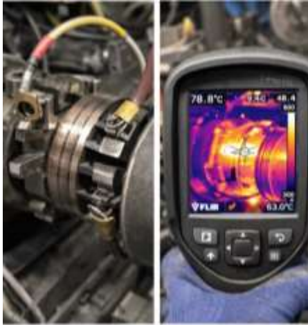
Рисунок 2.3 – Приклад термографічного контролю колекторно-щіткового вузла
