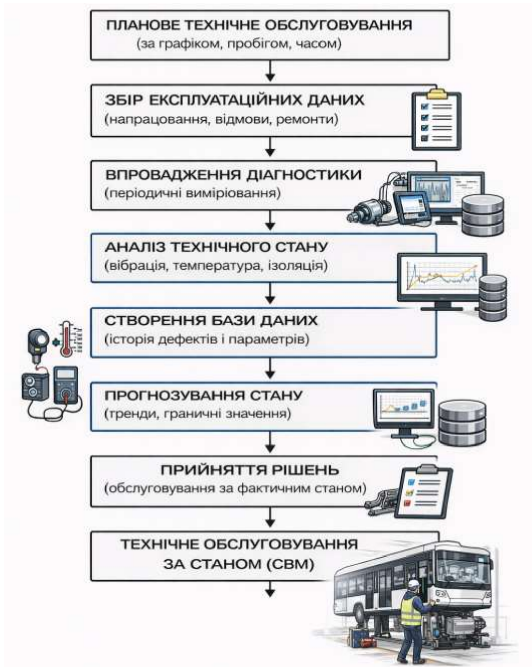
Рисунок 2.8 - Модель переходу від планового технічного обслуговування до технічного обслуговування за станом для міського електричного транспорту
