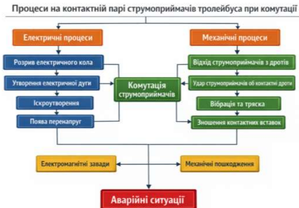
Рисунок 1.5 – Схема процесів на контактній парі при комутації [4,5]
