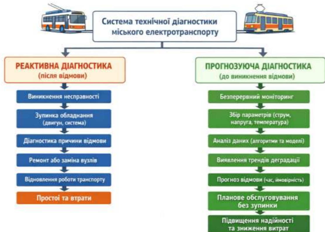
Рисунок 2.7 – Порівняння реактивної та прогнозуючої діагностики [8]
