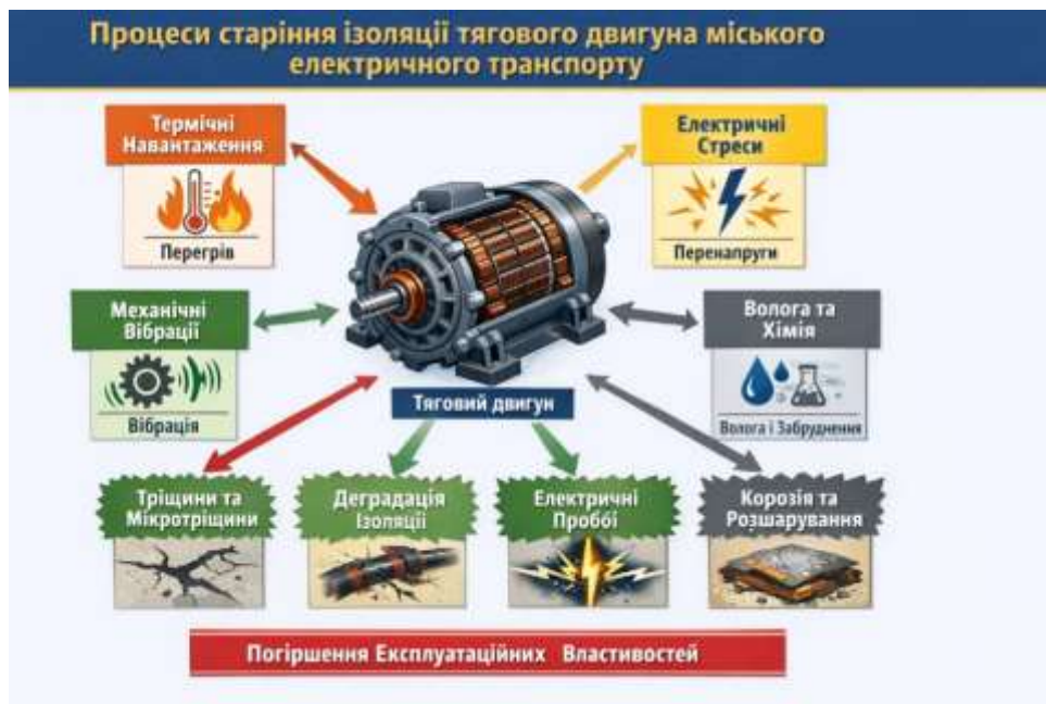
Рисунок 1.1 – Схема процесів старіння ізоляції тягового двигуна [5-7]
