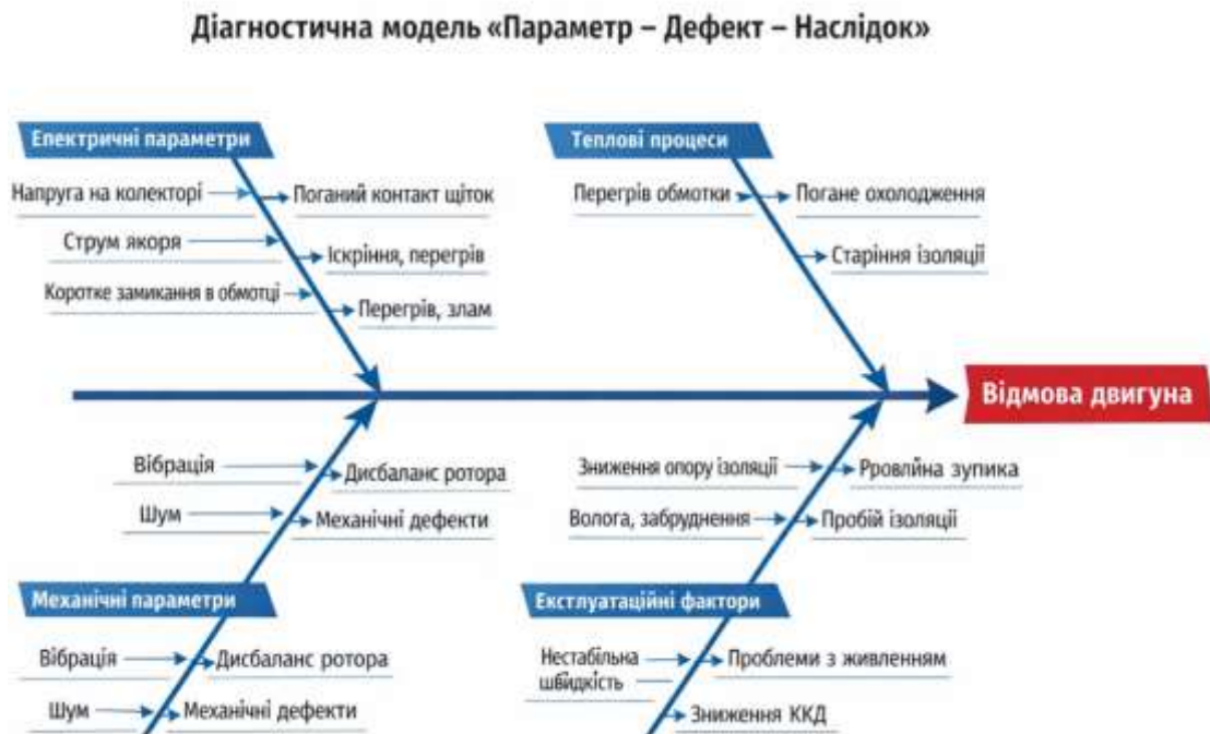
Рисунок 3.2 – Структурна модель діагностики [14]
