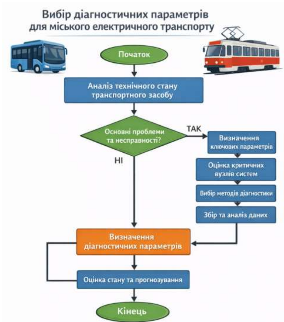
Рисунок 3.1 – Алгоритм вибору діагностичних параметрів [14]
