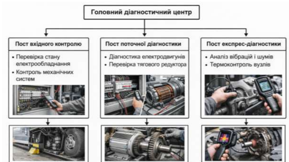
Рисунок 1.8 – Структурна схема діагностичних підрозділів депо [4,5]
