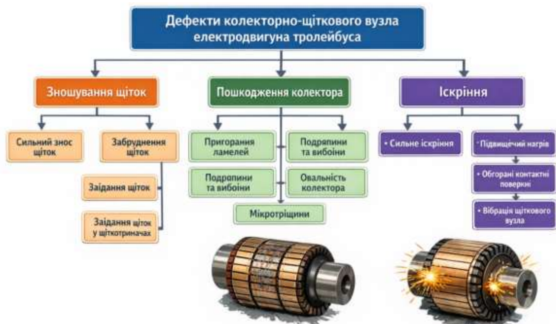
Рисунок 1.3 – Типові дефекти колекторно-щіткового вузла [5-7]
