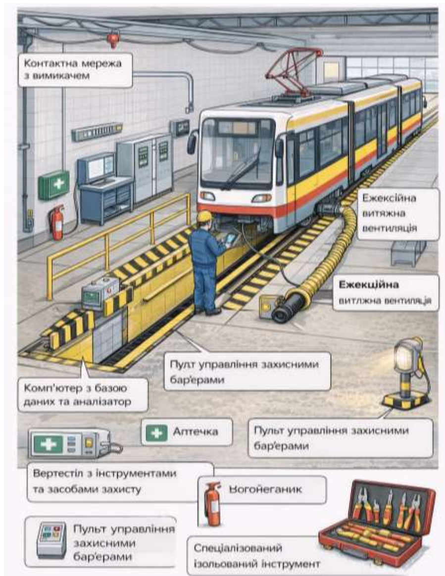
Рисунок 4.3 – Структура діагностичного поста [20]
