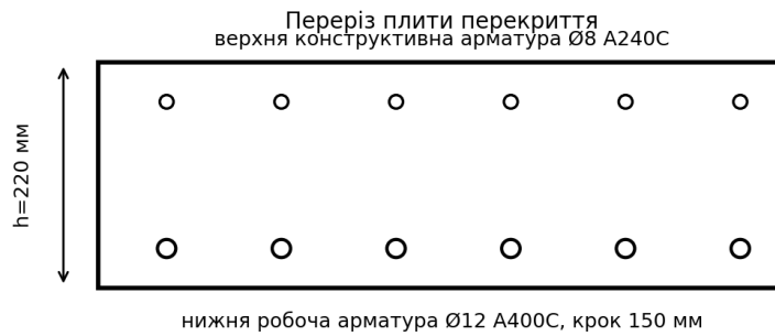
Рисунок 2.2.2 - Схема армування перерізу монолітної плити перекриття
