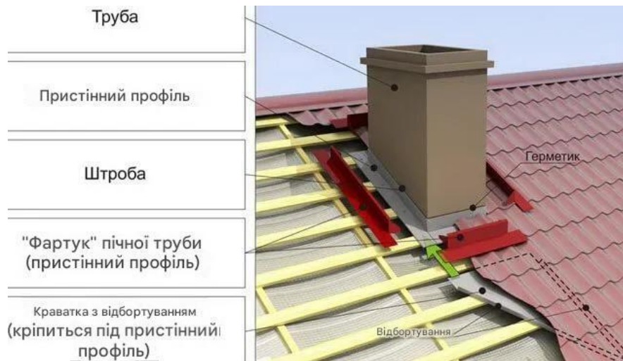
Рисунок 3.4.5 – Схема облаштування примикань
