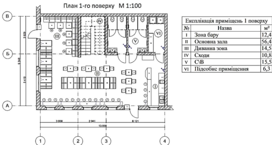
Рисунок 10 – Приклад виконання плану першого поверху
