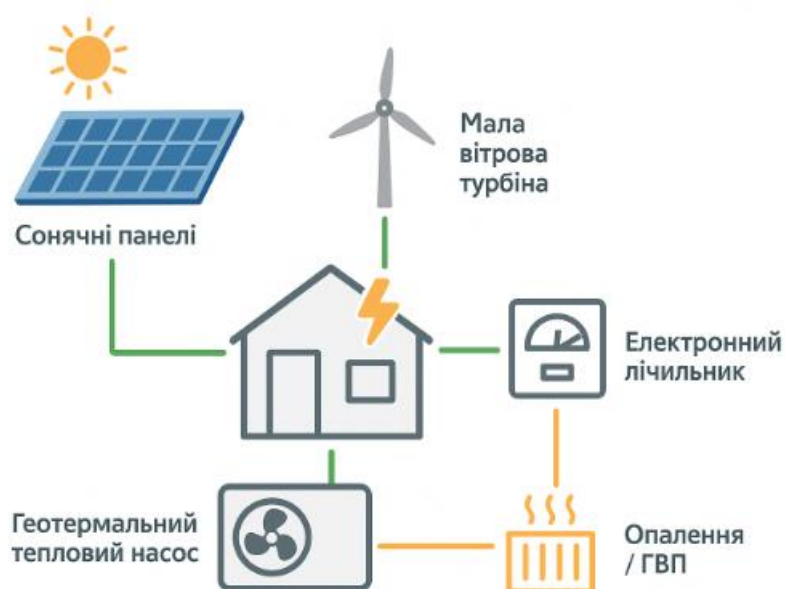
Рисунок 5.1 – Гібридна система енергозабезпечення житлового будинку
