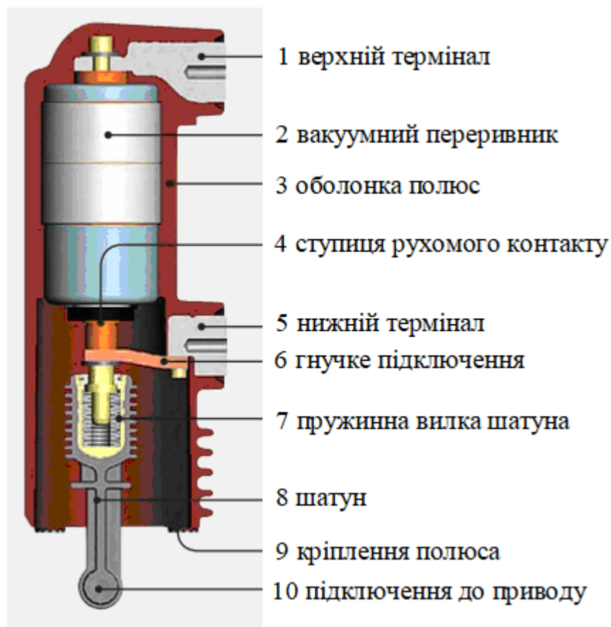
Рисунок 2.8 – Вакуумний переривник, вбудований в корпус вимикача [14]
