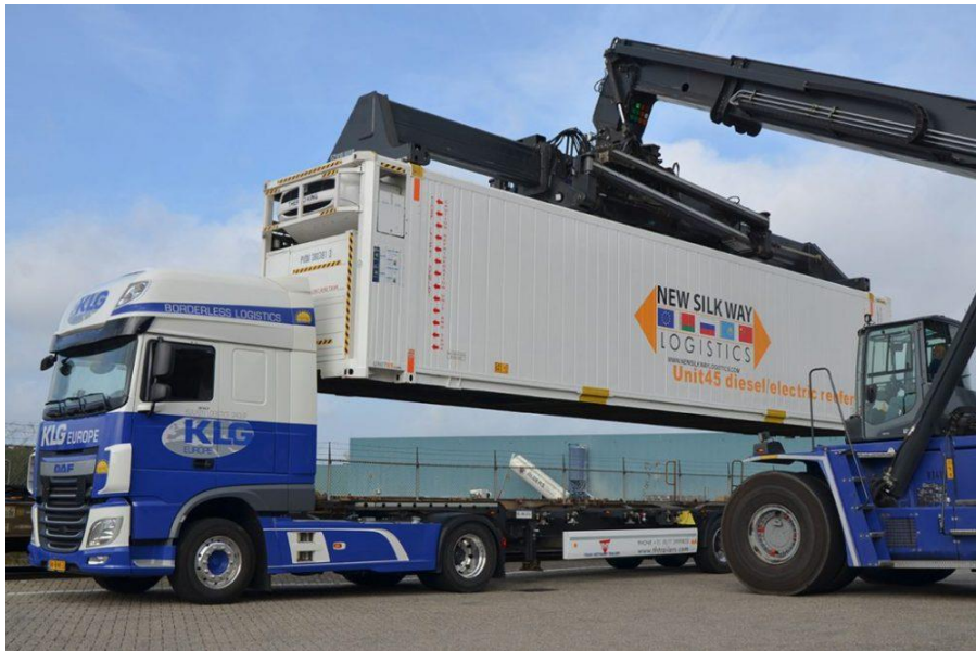
Рисунок 3.3 – Приклад навантаження 40-футового контейнера-рефрижератора на напівпричіп-контейнеровоз
