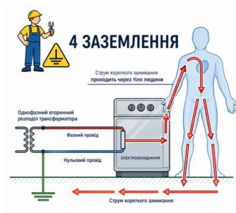
Рисунок 4.1 – Схема заземлення та струм к.з., що проходить через тіло людини
