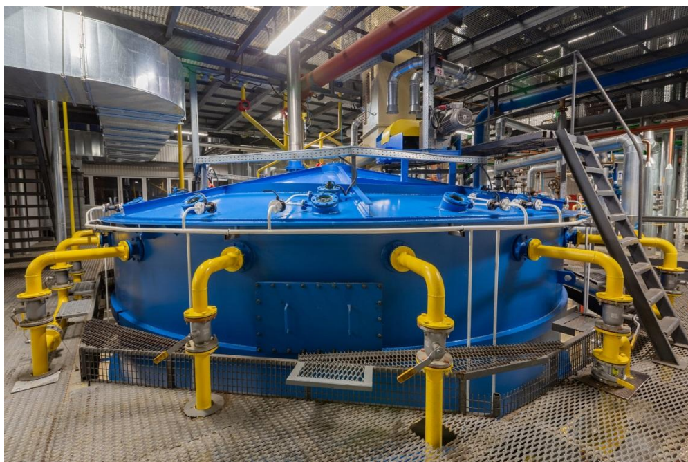
Рисунок 2.7 – Обладнання для екстракції рослинної олії (зовнішній вигляд екстрактора)
