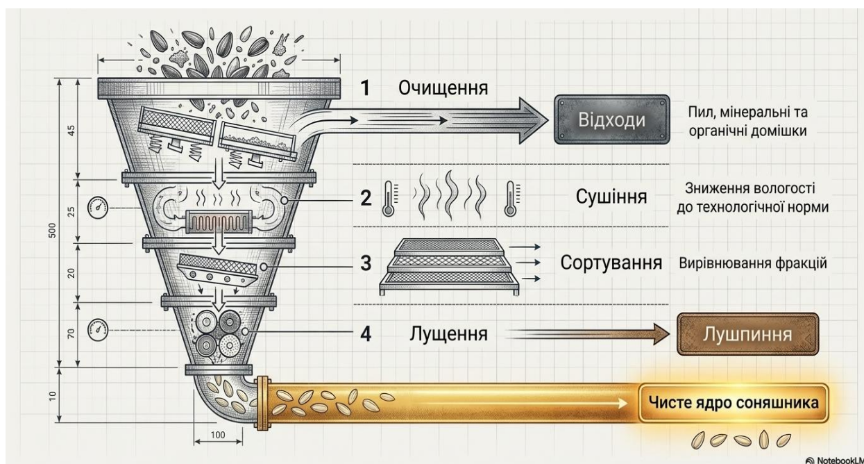
Рисунок 2.3 – Базова схема очищення насіння в сепараторі з закритим повітряним циклом
