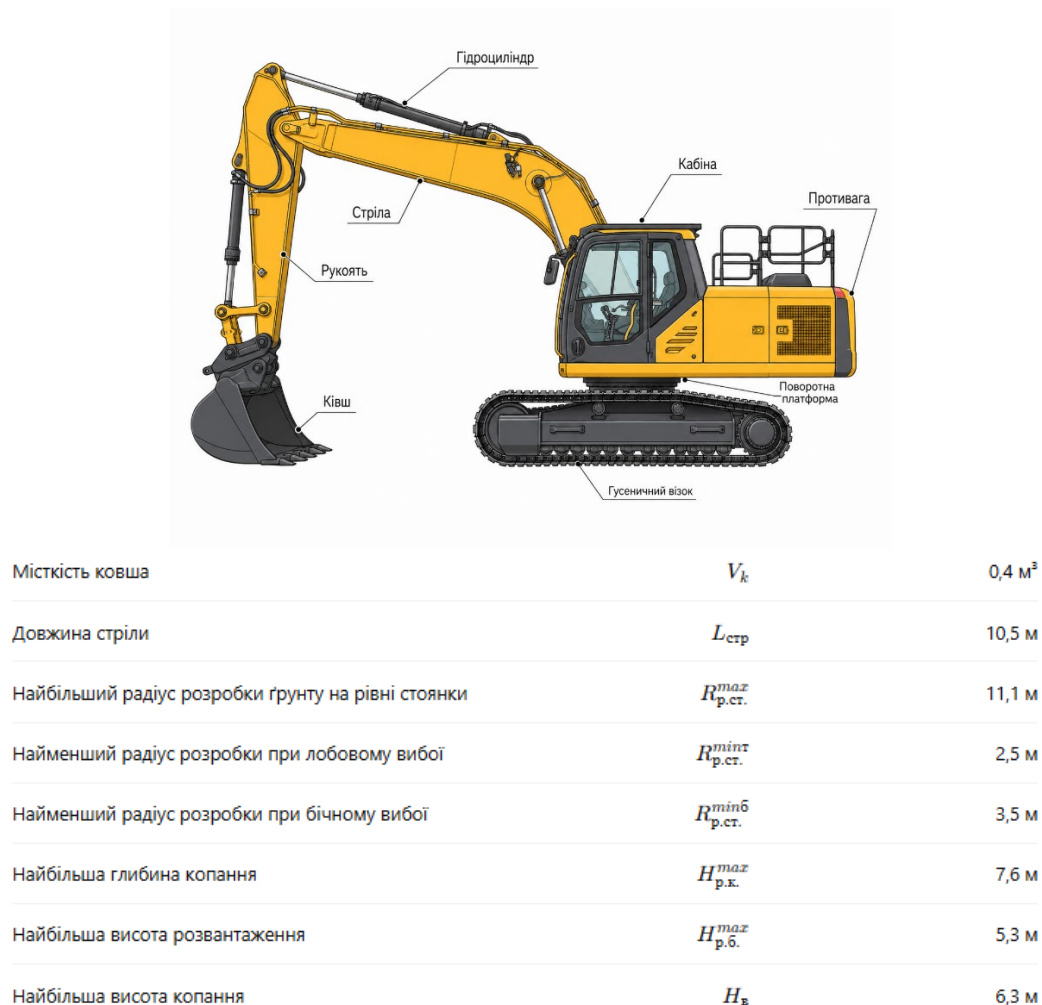
Рисунок 32 – Схема та характеристики екскаватора JCB 220X
