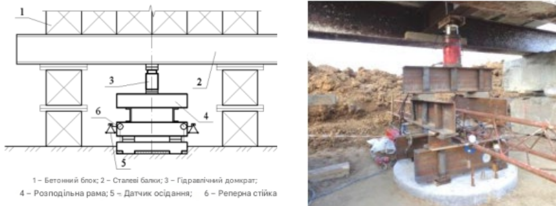
Рисунок 9 – Натурні випробування для ПФКШ
