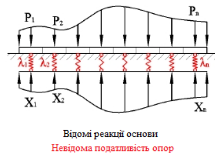
Рисунок 14 – Схема зворотної задачі визначення параметрів компенсуючого шару
