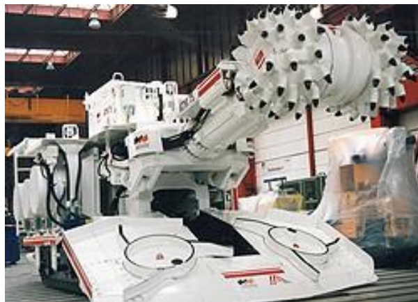
Рисунок 4.10 – Прохідницький комбайн AM-75 «Alpine miner» компанії «Тамрок»
