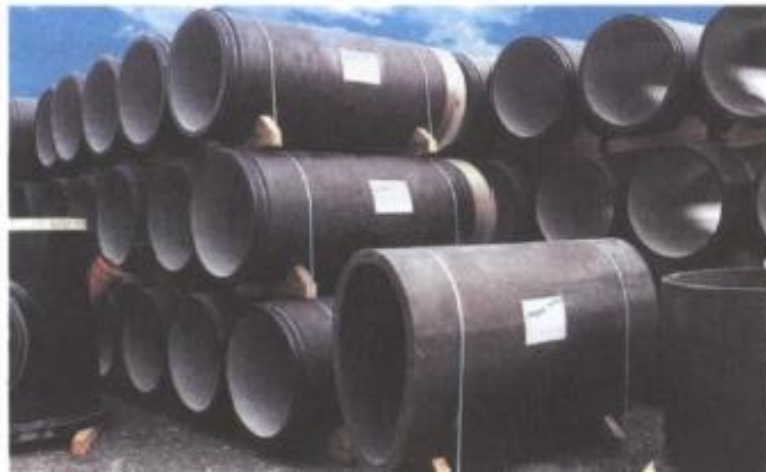
Рисунок 8.4 – Загальний вигляд нових труб з еластомірним ущільненням у стиках для прокладання трубопроводів
