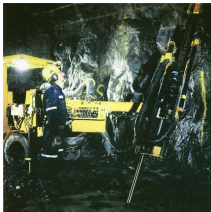
Рисунок 4.12 – Устаткування «Atlas Copco Boltex LB» для встановлення анкерів
