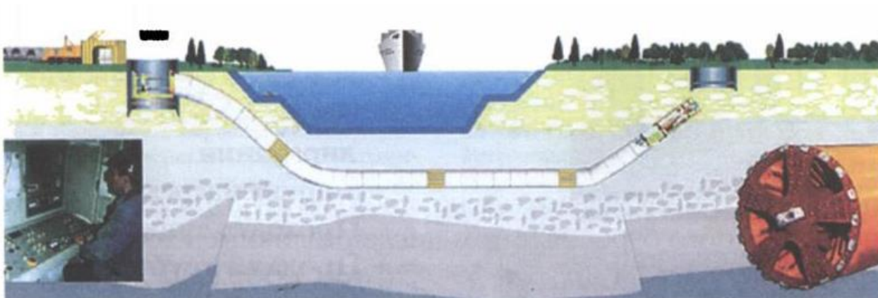
Рисунок 8.8 – Схема прокладання комунікаційного трубопроводу під річкою
