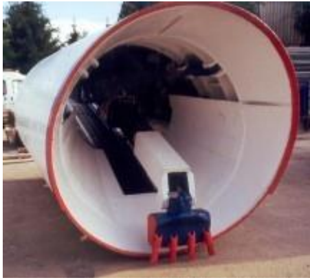
Рисунок 4.19 – Щит із робочим органом екскаваторного типу
