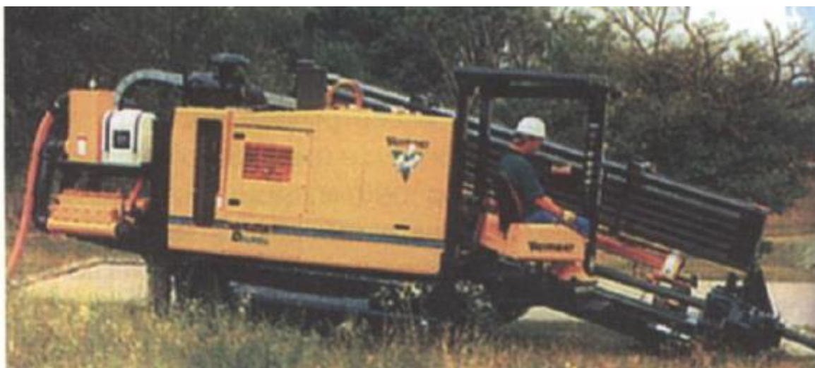
Рисунок 8.10 – Верстат спрямованого буріння «Вермеєр-Навігатор» (Тип D 50 × 100)
