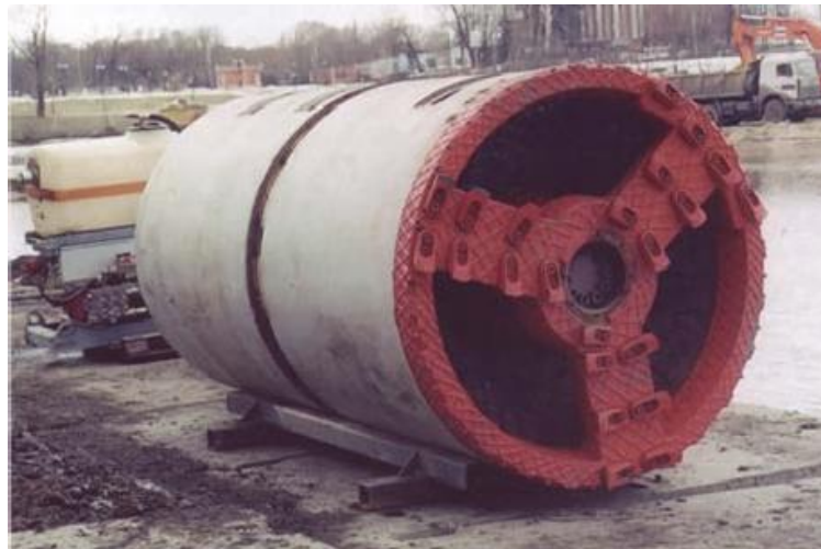
Рисунок 8.3 – Бурова головка мікрошцита «Perforator GmbH» MTS-2000
