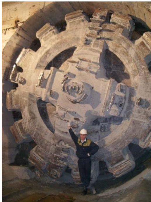
Рисунок 4.18 – Робочий орган механізованого щита роторного типу КТ1-5,6 під час будівництва станції метро
