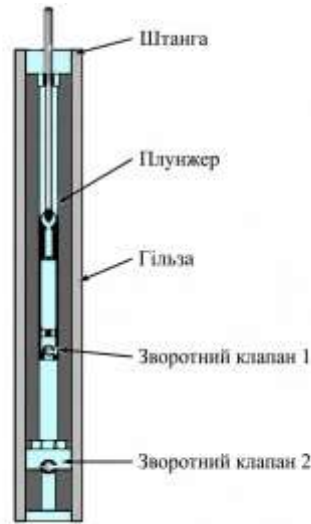
Рисунок 2.4 - Схема свердловинного штангового насоса
