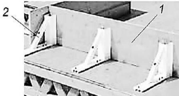
Рисунок 3.11 – Схема закріплення торцевих листів опалубки
