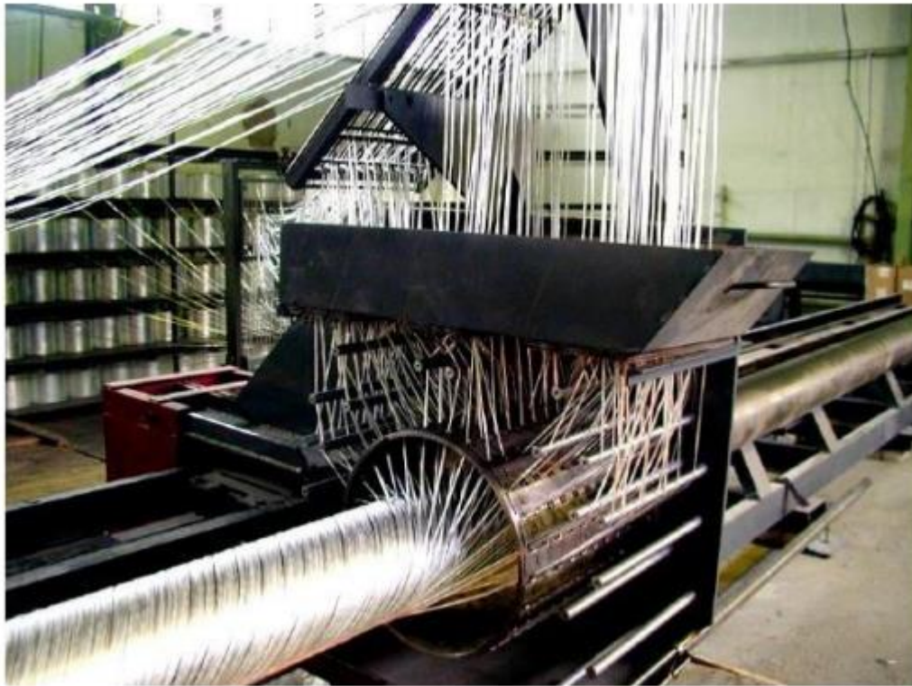
Рисунок 2.4 – Процес виготовлення композитної опори
