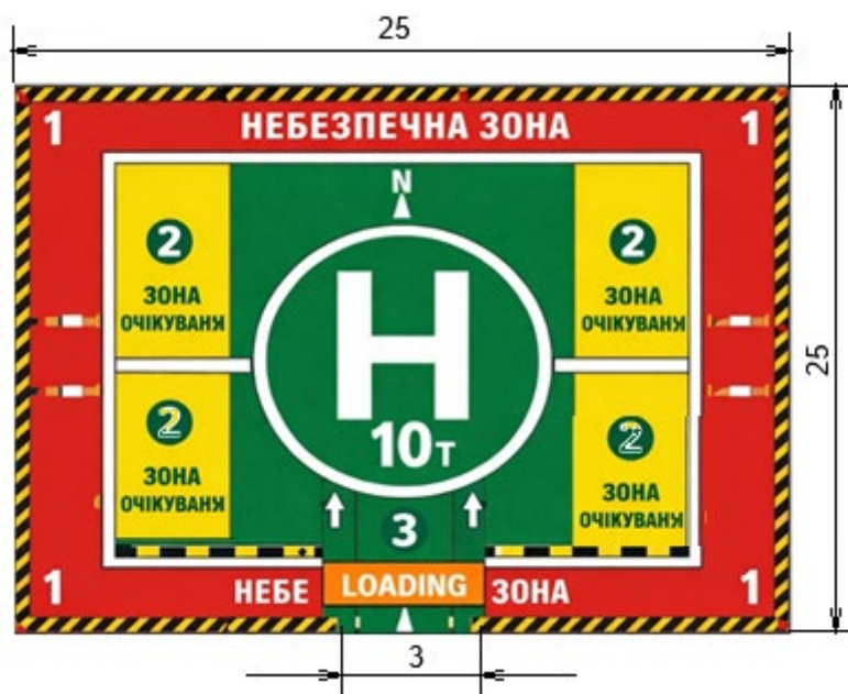
Рисунок 3.1 – Безпекова розмітка гелікоптерного майданчика: 1 – небезпечна зона; 2 – зона очікування; 3 – коридор руху медичного персоналу
