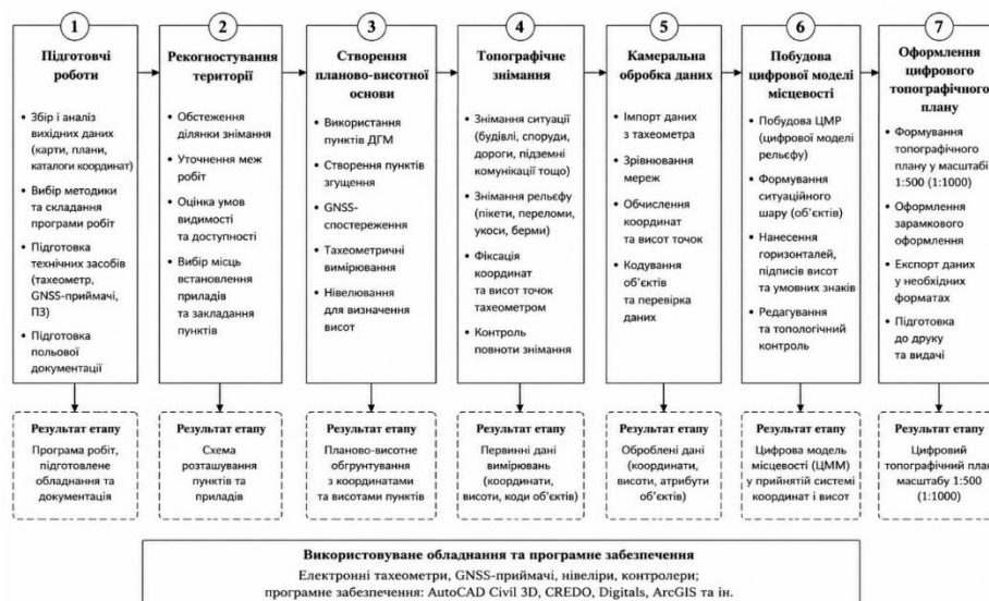
Рисунок 2.1 – Технологічна схема створення цифрового топографічного плану з використанням електронних тахеометрів та спеціалізованого програмного забезпечення
