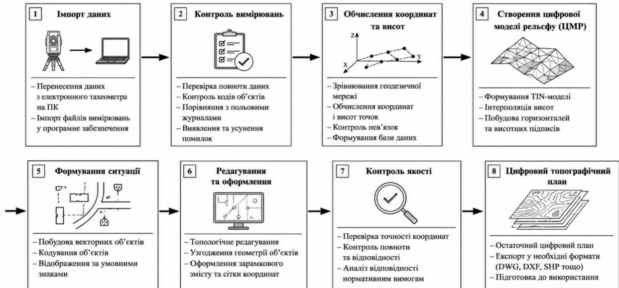
Рисунок 2.2 – Технологічна схема камеральної обробки результатів топографічного знімання
