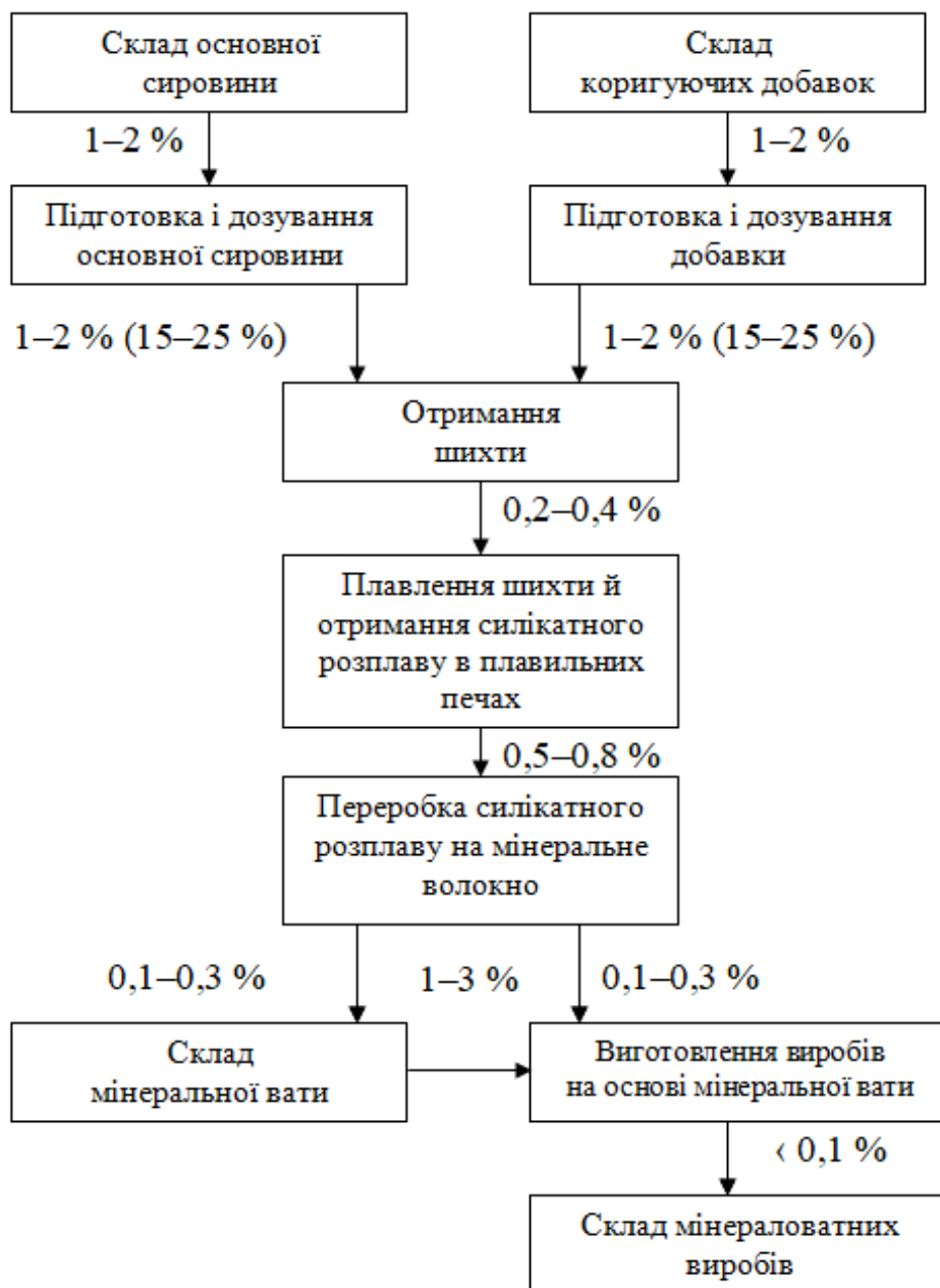
Рисунок 1.1 – Загальна технологічна схема виробництва мінеральної вати
